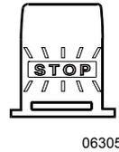
Ce témoin s'allume lorsque les feux stop arrière sont allumés. Ceci se produit lorsque l'interrupteur DECEL du régulateur de croisière, les freins de service, le frein de stationnement, le frein moteur ou le ralentisseur de la transmission sont mis en fonction.
