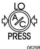
Lorsque la pression du système de climatisation est trop basse, ce témoin lumineux s'allume, le compresseur est débrayé et le ventilateur du condenseur s'arrête.
