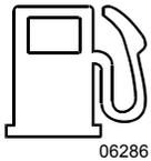
Ce témoin s'allume lorsqu'il reste environ 45 litres (12 gallons US.) dans le réservoir. Il est recommandé de ne pas franchir plus de 100 kilomètres (62 milles) alors que le témoin est allumé. Faire le plein dès que possible.
