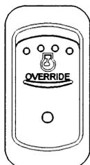
Basculer l'interrupteur pour annuler pendant 30 secondes le système d'arrêt d'urgence du moteur. L'annulation de l'arrêt d'urgence du moteur peut être prolongée en basculant à nouveau l'interrupteur, avant la fin de la période en cours. Cette fonction peut être particulièrement utile en cas de panne, pour amener le véhicule dans un endroit sûr à proximité.
