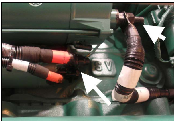
Figure 26: Câbles du démarreur protégés avec le revêtement de protection Color Guard.
