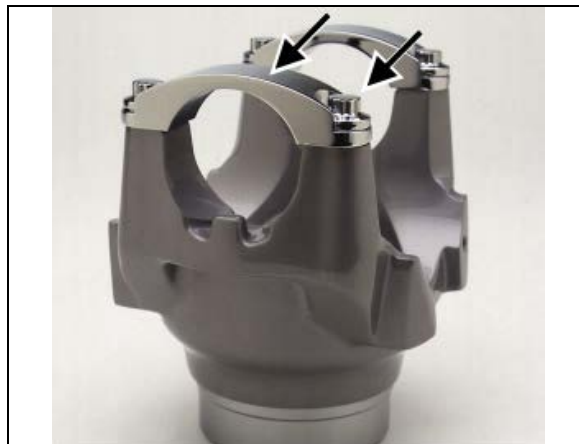
FIGURE 3: RETENUES DU PALIER ET BOULONS UTILISÉS SUR VÉHICULES PREVOST
