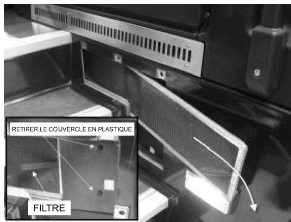
FIGURE 17 : DÉMONTAGE DES FILTRES À AIR DE L'UNITÉ DU CONDUCTEUR
