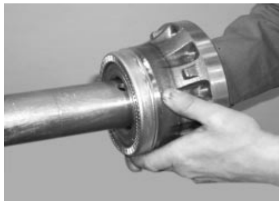
FIGURE 20 : FAIRE GLISSER LE ROULEMENT DU MOYEU UNIFIÉ PAR-DESSUS LA FUSÉE.
