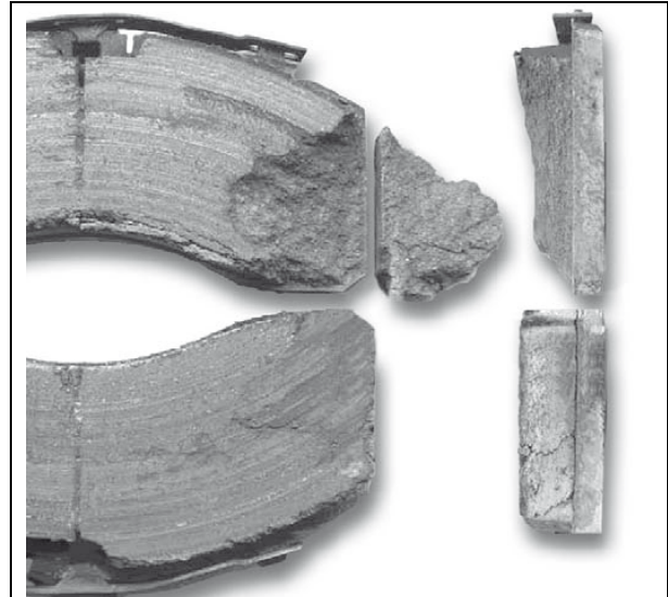
FIGURE 27 : DES RUPTURES MAJEURES À LA SURFACE DES PLAQUETTES DE FREIN SONT INTERDITES.
