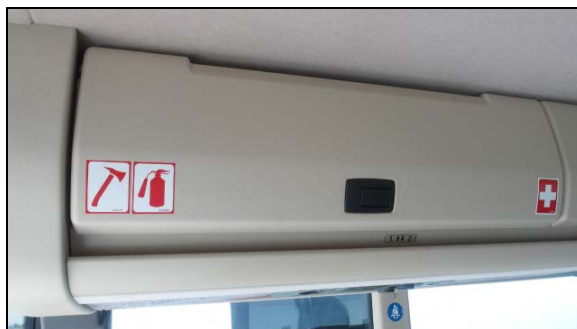
LA PRÉSENCE D'UN AUTOCOLLANT INDIQUE QU'UN EXTINCTEUR (OPTION) EST RANGÉ DANS CE PORTE-BAGAGES À MAIN
