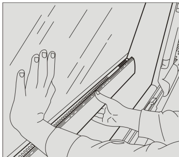
Fenêtres d'urgence avec mécanisme d'ouverture à la base du verre de la fenêtre.
