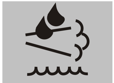
Témoin de bas niveau de solution d'urée ( DEF ) dans les témoins du tableau de bord.
