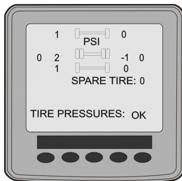
Écran du système de contrôle de la pression des pneus (TPMS).
