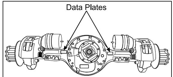
FIGURE 5 : TYPICAL SERIAL AND MODEL NUMBERS<sup>11019</sup>
