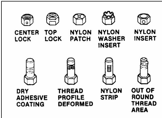
FIGURE 14 : SELF-LOCKING FASTENERS 00004
