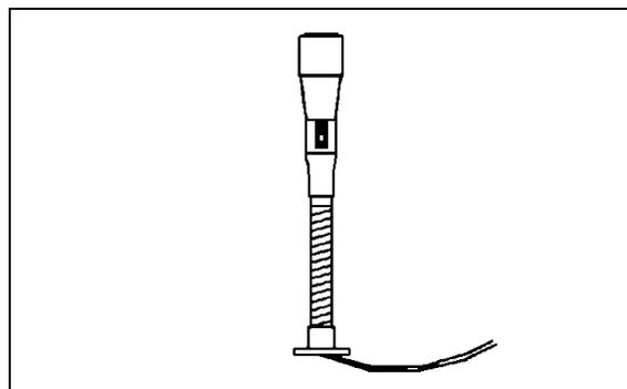
FIGURE 9: BOOM-TYPE MICROPHONE 23083
