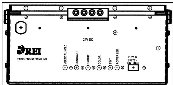
FIGURE 15: MONITOR HOUSING REAR PANEL 23333
