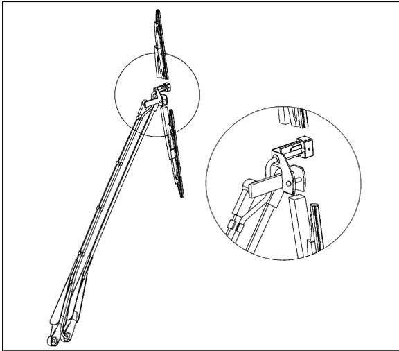
FIGURE 35: WINDSHIELD WIPER ( DRIVER SIDE)
