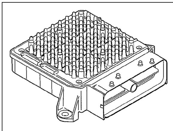
FIGURE 16: TRANSMISSION CONTROL MODULE 07140
