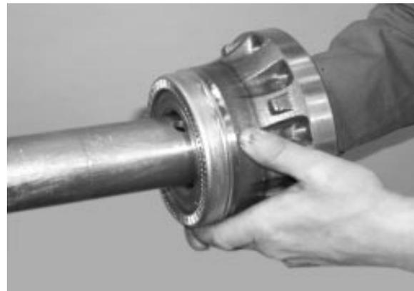
FIGURE 19: SLIDE UNITIZED HUB BEARING OVER SPINDLE
