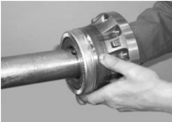
FIGURE 10: SLIP UNITIZED HUB BEARING OVER SPINDLE
