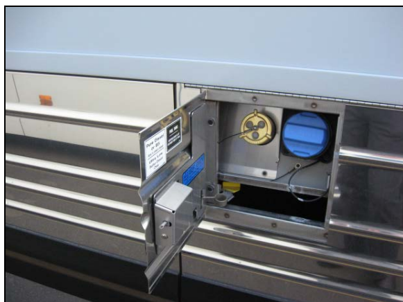
FUEL & DEF FILLER DOOR ON L.H SIDE
