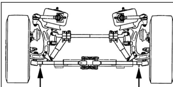
POINTS DE LEVAGE SUR UNE SUSPENSION IND. 16139
