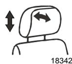
L'appui-tête peut être pivoté vers l'avant ou vers l'arrière et s'ajuste verticalement sur une hauteur de 50 mm (2 pouces) en le glissant vers le haut ou le bas.
