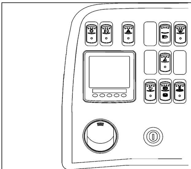
Le panneau de commande gauche du tableau de bord comprend les interrupteurs de commande pour la conduite de l'autocar. Il comprend également le commutateur d'allumage et une bouche d'air réglable pour le conducteur.
