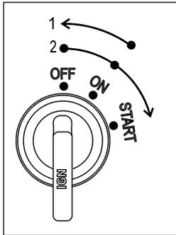
1. À partir de la position ON, placer le commutateur à la position OFF
