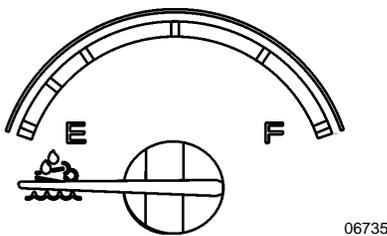
Indique la quantité présente de fluide d'échappement diesel DEF (Diesel Exhaust Fluid) dans le réservoir. Le réservoir a une capacité de 60 litres. Une bonne pratique consiste à faire le plein de DEF à tous les deux pleins de carburant.
