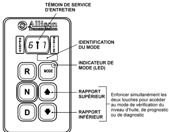
**PROCEDURE D’AFFICHAGE ET D’EFFACEMENT DES CODES D’ANOMALIE – COMMANDES ALLISON 4<sup>E</sup> GENERATION**
