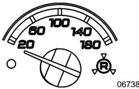
Indique la pression d'air du système de freinage arrière. La pression normale de fonctionnement se situe entre 95 et 125 psi.
