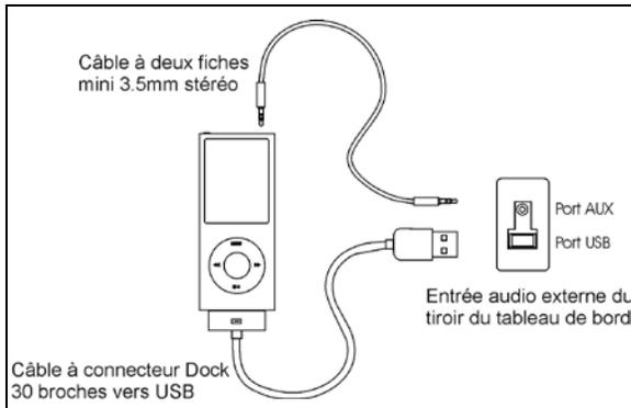
**CONNEXION D'UN IPOD AVEC DEUX CÂBLES SÉPARÉS**
