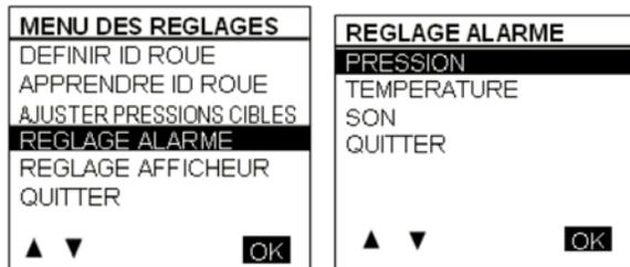
En sélectionnant «ALARME PRESSION» l'écran montré ci-après apparaît. Un écran semblable est défini pour le réglage des températures. Le curseur peut être déplacé pour mettre en évidence la valeur située à côté de «NOUVELLE VALEUR», «ACCEPTER» ou «QUITTER». +/- permet d'augmenter ou de diminuer les valeurs. La
