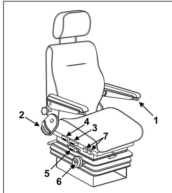
SIÈGE DU CONDUCTEUR À SUSPENSION MÉCANIQUE<sup>18333</sup>
