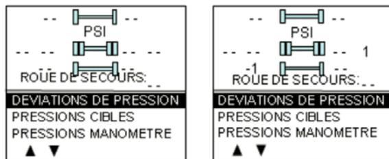
Tel qu'illustré, les lectures de pression apparaissent en remplacement des tirets à mesure que l'afficheur du TPMS reçoit les données du récepteur du TPMS. Cela peut prendre 1 minute avant que toutes les lectures de pression parviennent à l'afficheur puisque les capteurs transmettent à intervalle de 1 minute.
