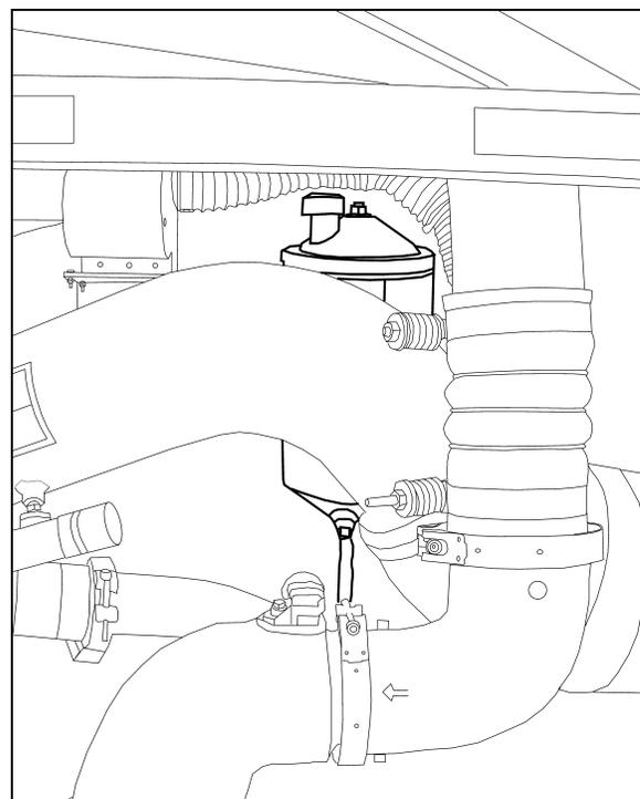
RÉSERVOIR DE FLUIDE DE LA DIRECTION ASSISTÉE 14059
