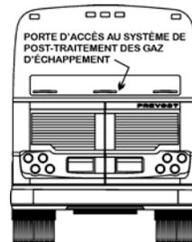
Les portes d'accès au moteur doivent être ouvertes avant d'ouvrir la porte d'accès au système de post-traitement des gaz d'échappement. Pour ouvrir la porte, abaisser le levier de libération du loquet en utilisant un tournevis à bout plat.
