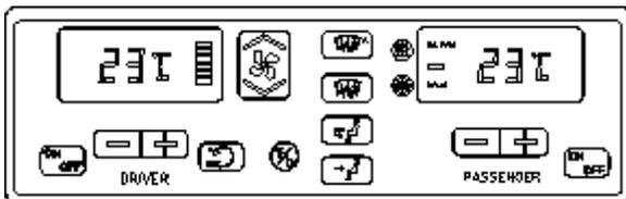
L'intérieur de l'autocar est pressurisé par le système de chauffage et de climatisation afin de prévenir l'introduction de la poussière et de l'humidité. Le débit d'air et les commandes divisent l'intérieur de l'autocar en deux zones ; la section du conducteur incluant le dégivreur et la section des passagers.
