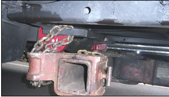
TOUJOURS ARRIMER LES OEILLETS AU DISPOSITIF DE LEVAGE DU CAMION
