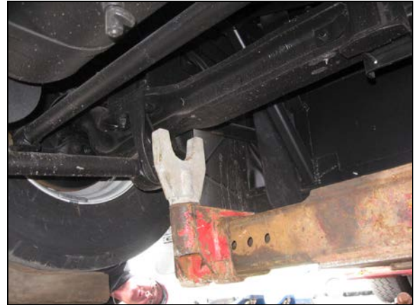
LEVAGE PAR L'ESSIEU AVANT
