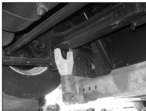
LEVAGE PAR L'ESSIEU AVANT
