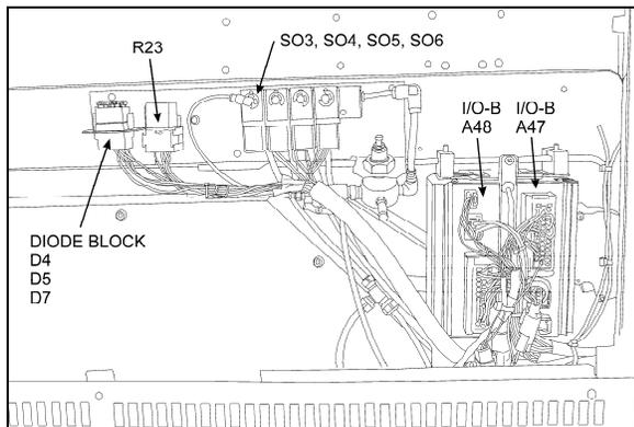
**FIGURE 17: ENTRANCE DOOR & WIPER CONTROL PANEL**
