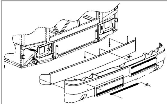
FIGURE 54: FRONT BUMPER REMOVAL
