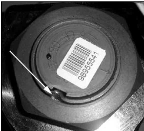
FIGURE 20 : MARQUE DU POINÇON D'ÉCROU DE FIXATION
