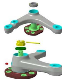
9. Serrer l'écrou à un couple de 130 lbf-pi.
