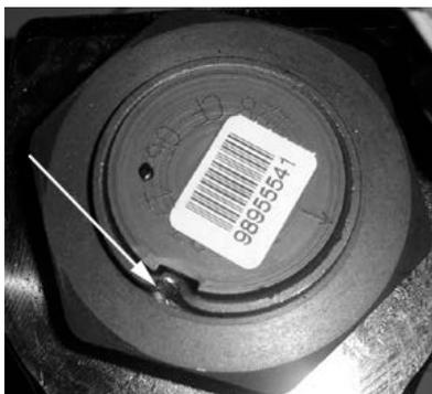
**FIGURE 15 : MARQUE DE POINÇON D'ÉCROU DE FIXATION**
