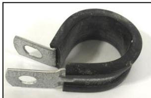
Figure 18: Les colliers métalliques de type P-clamp ne sont plus utilisés pour attacher les câbles de puissance, par contre ils peuvent se trouver sur les véhicules des précédentes générations. Le revêtement de caoutchouc doit impérativement être en place sur le collier. Remplacer tout collier dont le revêtement de caoutchouc est absent, brisé ou susceptible de se réparer.
