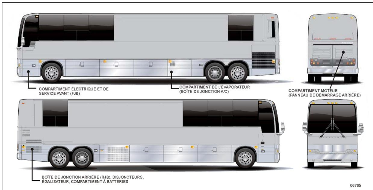
FIGURE 13 : COMPARTIMENTS ÉLECTRIQUES (X3-45 VIP)
