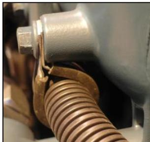
Figure 19: Le diamètre approprié du collier de type P-clamp prévient le mouvement et le frottement du câble de puissance ou de la gaine protectrice ondulée.
