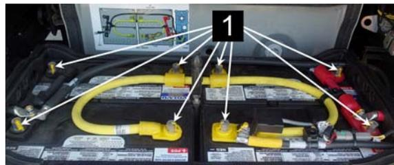
FIGURE 41: INSTALLER LES VIS DE CÂBLES DES BATTERIES
