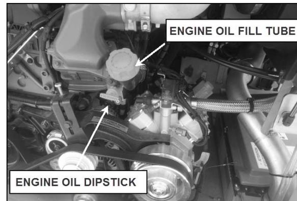
ENGINE OIL DIPSTICK - VOLVO D13 ENGINE 01192\_2
