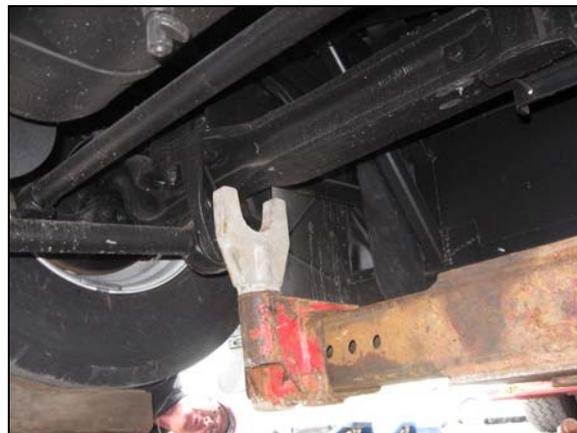
LIFTING FROM UNDER THE FRONT AXLE
