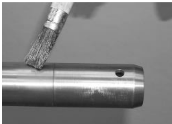
FIGURE 19 : APPLIQUER LA GRAISSE GLEITMO 805
