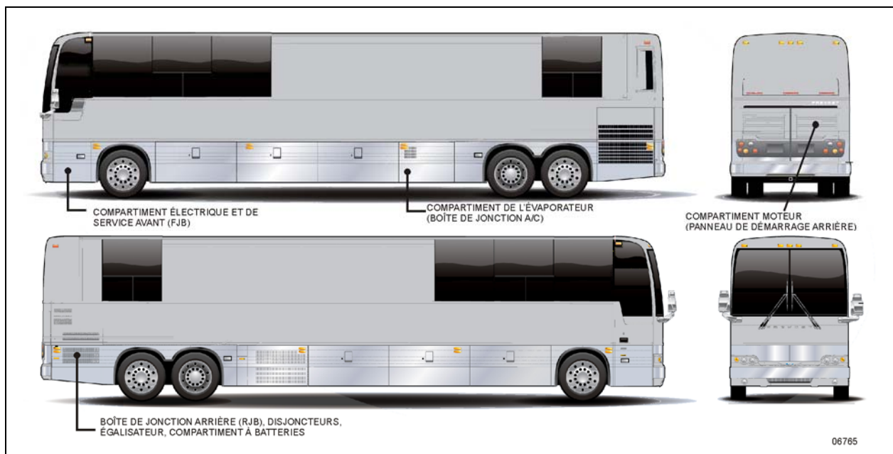
FIGURE 13 : COMPARTIMENTS ÉLECTRIQUES (X3-45 VIP)
