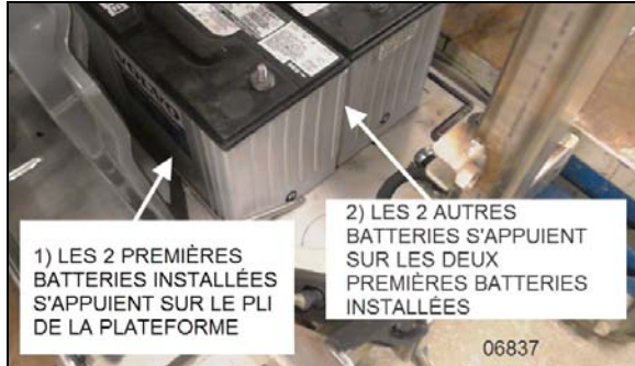
FIGURE 38: POSITION ADÉQUATE DES BATTERIES
