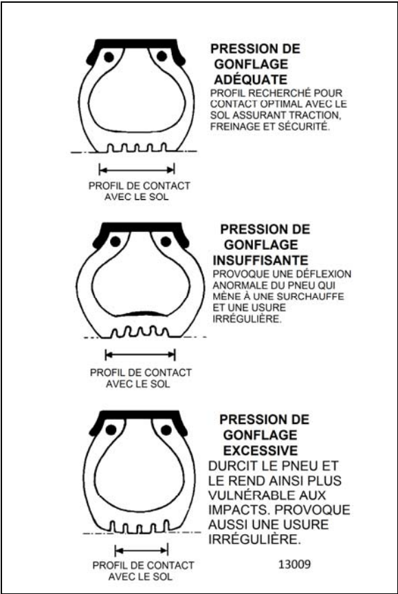
FIGURE 33 : GONFLAGE DES PNEUS
