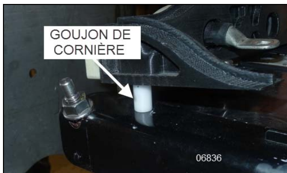
FIGURE 40 : GOUJON DE CORNIÈRE ET GUIDE DE CÂBLE
