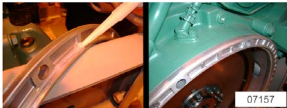
FIGURE 11: INSTALLATION DE L'ENTRETOISE D'ESPACEMENT
