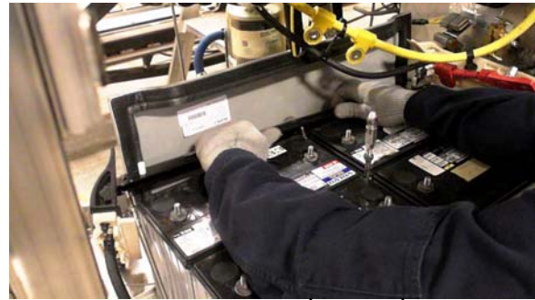
FIGURE 35: RETIRER LA CORNIÈRE ARRIÈRE
