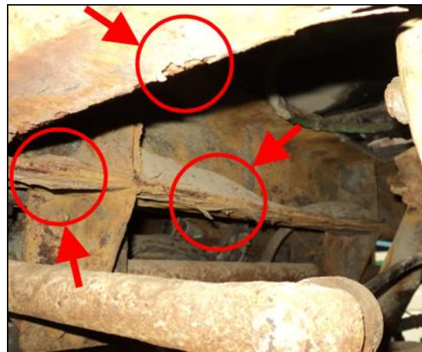
FIGURE 3: ÉCAILLAGE DU MÉTAL ET ACCUMULATION DE SABLE
