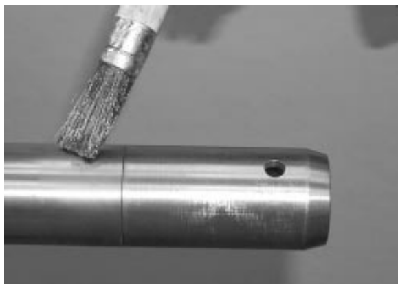
FIGURE 10 : APPLIQUER LA GRAISSE GLEITMO 805
