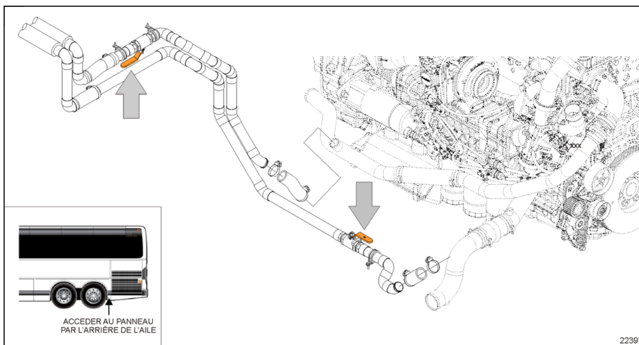
FIGURE 72 ROBINETS D'ARRÊT DE LA LIGNE DE CHAUFFAGE DE LA SÉRIE X (DISPOSITION DE TUYAUTERIE DE TRANSMISSION ALLISON ILLUSTRÉE)
