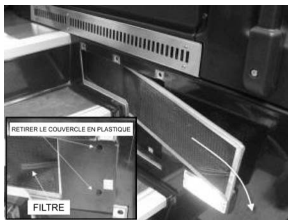
FIGURE 18 : DÉMONTAGE DES FILTRES À AIR DE L'UNITÉ DU CONDUCTEUR
