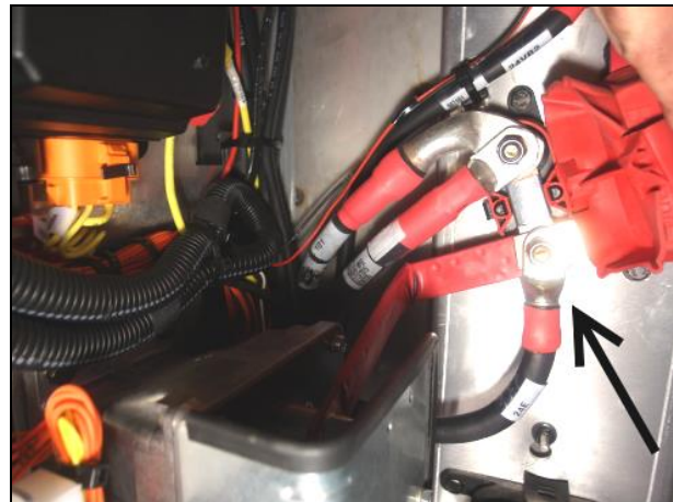
Figure 3: Bloc de jonction Bussman - Série H3
