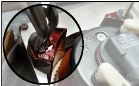
FIGURE 70: VERROUILLER LES TIGES FILETÉES
