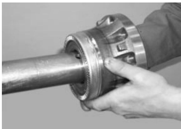
FIGURE 11 : FAIRE GLISSER LE ROULEMENT DE MOYEU INTÉGRÉ PAR-DESSUS LA FUSÉE
