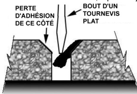
**9.10.3 Réparation d'un joint soudé**
