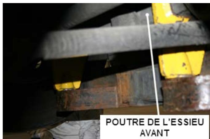
6. Installer une chandelle sous le bras télescopique en guise d'appui et pour des raisons de sécurité puis abaisser le bras télescopique pour qu'il repose sur la chandelle (Figure 47). Les blocs peuvent être retirés d'en dessous des roues avant.
