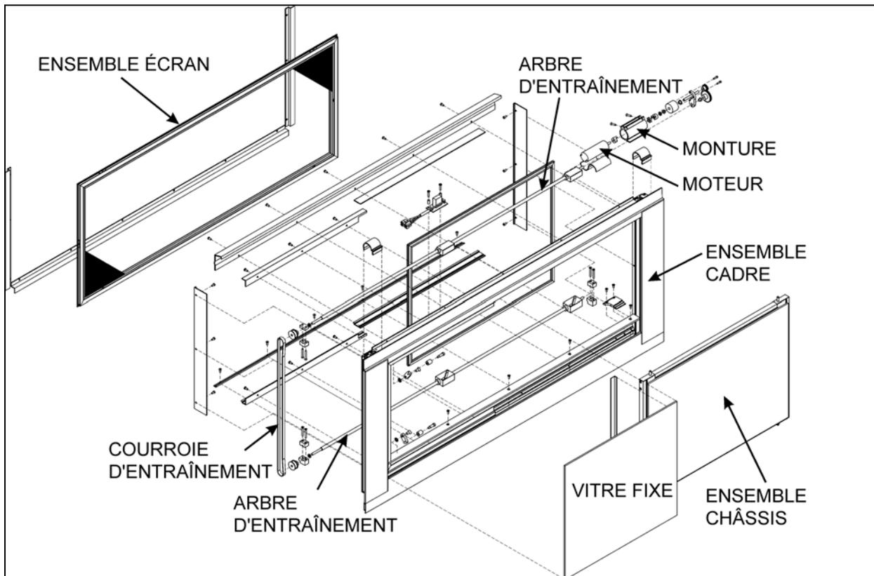
FIGURE 99 : VUE ÉCLATÉE D'UNE FENÊTRE ÉLECTRIQUE COULISSANTE
