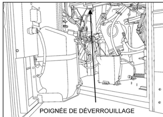
FIGURE 91: POIGNÉE DE DÉVERROUILLAGE DU PARE-CHOC AVANT 18613
