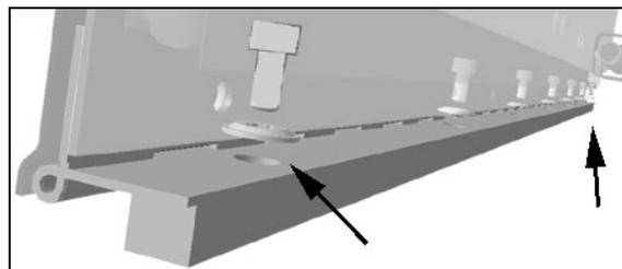
2. Fermer la porte et ajuster l'ouverture. Un écart de 1 mm maximum est toléré entre l'espace de gauche et celui de droite.
