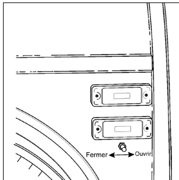
FIGURE 34: INTERRUPTEUR DE COMMANDE DE LA PORTE D'ENTRÉE 18599
