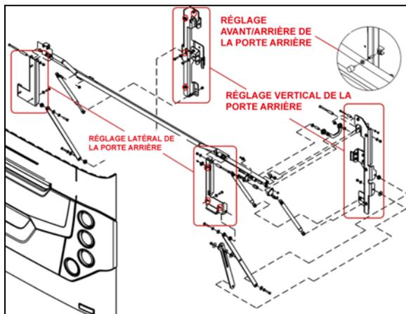
FIGURE 45 : PORTE DU COMPARTIMENT MOTEUR<sup>18633\_1</sup>
