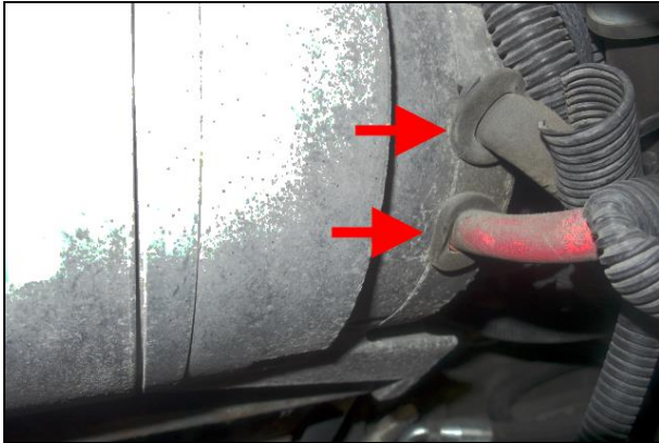
Figure 21: Alternateur Bosch T1 avec les deux passe-câbles (grommet) de caoutchouc requis. Les câbles qui s'insèrent à l'arrière des alternateurs doivent être protégés du bord métallique avec des passe-câbles de caoutchouc.
