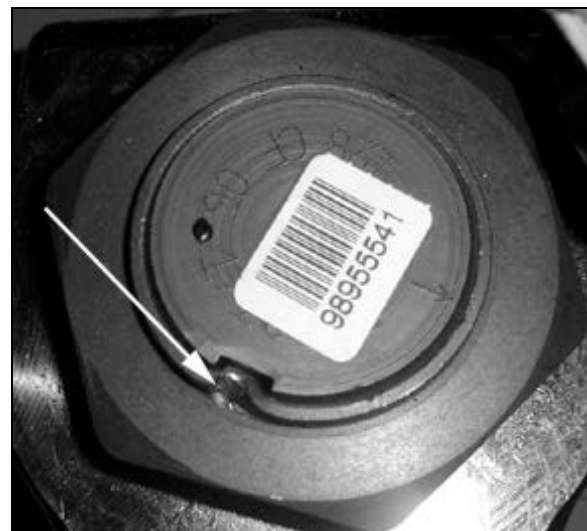
FIGURE 20 : MARQUE DE POINÇON D'ÉCROU DE FIXATION
