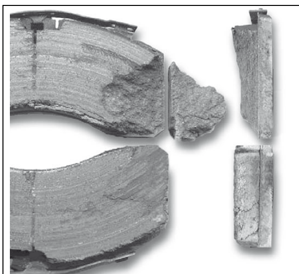
FIGURE 23: DES RUPTURES MAJEURES À LA SURFACE DES PLAQUETTES DE FREIN SONT INTERDITES
