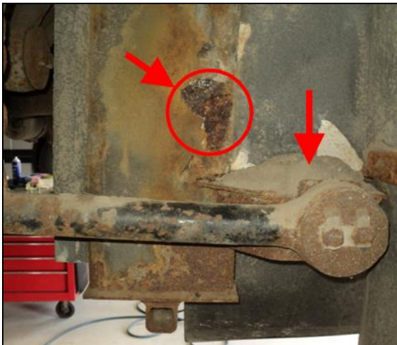
FIGURE 2: ÉCAILLAGE DU MÉTAL. L'ACCUMULATION DE SABLE COMME SUR CETTE IMAGE NE DEVRAIT PAS ÊTRE LAISSÉE EN PLACE
