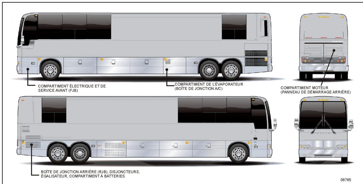
FIGURE 14 : COMPARTIMENTS ÉLECTRIQUES (X3-45 VIP)
