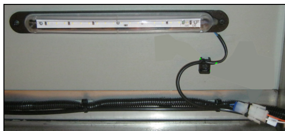
FIGURE 95: MODULES À DEL SCÉLÉ
