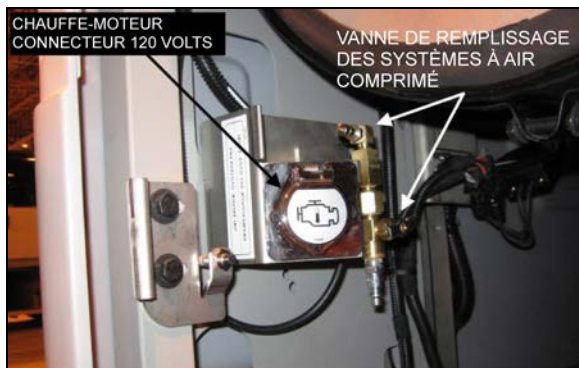
FIGURE 47: EMBLACEMENT DE SOUPAPE ARRIÈRE SUR LA SÉRIE X3
