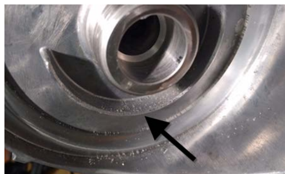
PARTICULES D'ALUMINIUM SUR LE RÉDUCTEUR DE DÉBIT (SUPPORT DE MONTAGE DES FILTRES)
