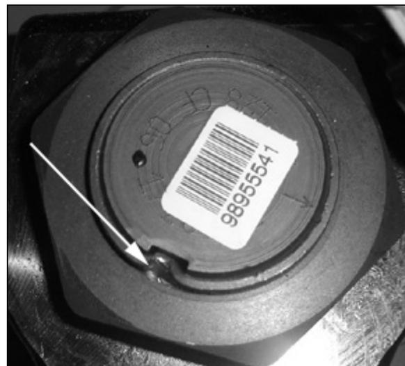
FIGURE 20 : MARQUE DE POINÇON D'ÉCROU DE FIXATION
