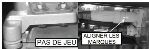
FIGURE 26: CHARNIÈRE INSTALLÉE ET CONNECTEUR BRANCHÉ
