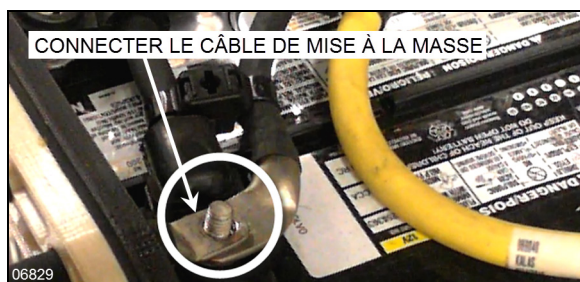
FIGURE 54: CÂBLE DE MISE À LA MASSE
