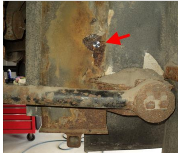
FIGURE 6: ZONE NETTOYÉE SUR LE CHÂSSIS
