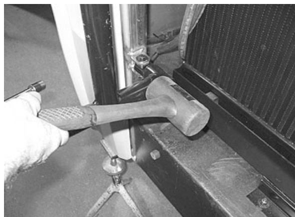
FIGURE 63: RÉGLAGE DE BRAS DE PANTOGRAPHE
