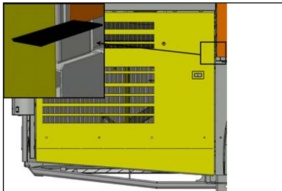
FIGURE 123: UTILISER UNE RÈGLE POUR VÉRIFIER SI LES SURFACES SONT AU MÊME NIVEAU
