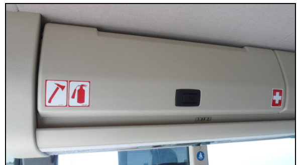
LA PRÉSENCE D'AUTOCOLLANTS INDIQUE QU'UNE HACHE D'INCENDIE, UN EXTINCTEUR ET UNE TROUSSE DE PREMIERS SOINS SONT RANGÉS DANS CE PORTE-BAGAGE À MAIN
