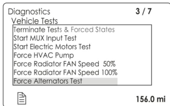
Pour lancer le test, utiliser le menu DIAGNOSTICS de l'écran d'affichage (DID). Choisir le sous-menu VEHICLE TESTS / TESTS VÉHICULE, puis FORCE ALTERNATORS TEST / ACTIVER TEST ALTERNATEURS. Appuyer sur la touche ENTER pour démarrer le test. Cette fonctionnalité activera un à la suite de l'autre pendant 5 secondes, les alternateurs 1, 2 & 3.
