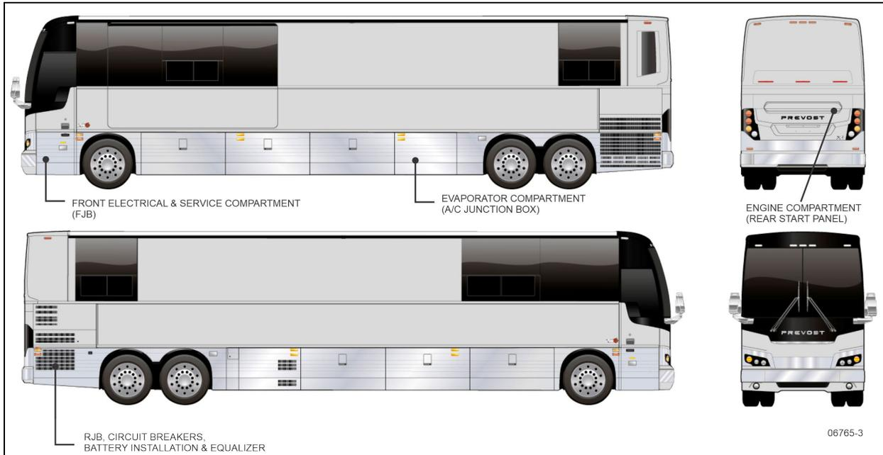
FIGURE 15 : COMPARTIMENTS ÉLECTRIQUES (CARROSSERIE X3-45 VIP COMMERCIAL)
