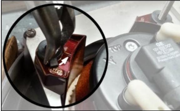
FIGURE 75: VERROUILLER LES TIGES FILETÉES
