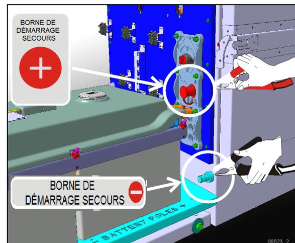
FIGURE 57 : BORNES DE DÉMARRAGE-SECOURS – SÉRIE X3
