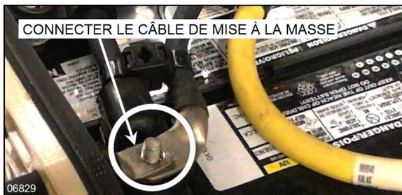
**FIGURE 54: CÂBLE DE MISE À LA MASSE**
