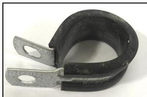
Figure 18: Les colliers métalliques de type P-clamp ne sont plus utilisés pour attacher les câbles de puissance, par contre ils peuvent se trouver sur les véhicules des précédentes générations. Le revêtement de caoutchouc doit impérativement être en place sur le collier. Remplacer tout collier dont le revêtement de caoutchouc est absent, brisé ou susceptible de se réparer.
