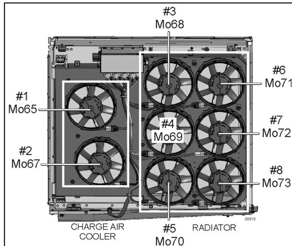
FIGURE 7: IDENTIFICATION DES VENTILATEURS DE REFROIDISSEMENT
