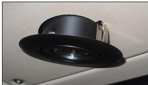
FIGURE 109: PLAFONNIER AU-DESSUS DE L'ESPACE DU CONDUCTEUR
