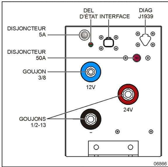
FIGURE 59: MODULE DE DÉMARRAGE
