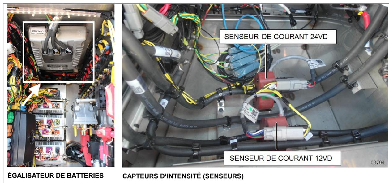
FIGURE 61 : COMPOSANTS ÉLECTRIQUES DU SYSTÈME PRIME
