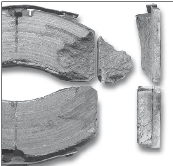
FIGURE 20: PLAQUETTE DE FREIN AVEC DÉGRADATION MINEURE (TOLÉRÉE)
