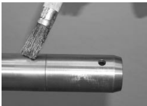
FIGURE 19 : APPLIQUER LA GRAISSE GLEITMO 805
