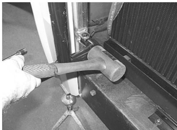
FIGURE 66: RÉGLAGE DE BRAS DE PANTOGRAPHE
