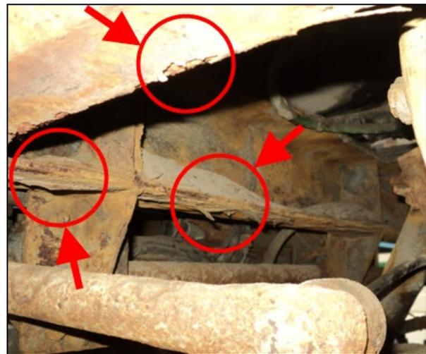
FIGURE 3: ÉCAILLAGE DU MÉTAL ET ACCUMULATION DE SABLE
