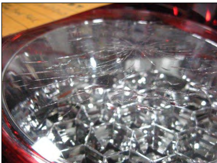
FIGURE 3: Fendillement de la surface extérieure du feu arrière dû à l'utilisation de dégraissant à moteur
