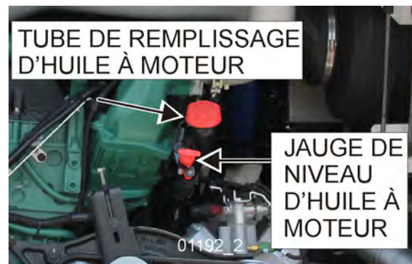
FIGURE 10 : TUBE DE REMPLISSAGE D'HUILE À MOTEUR ET JAUGE DE NIVEAU TYPIQUE
