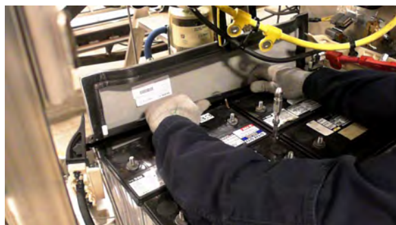
FIGURE 47: RETIRER LA CORNIÈRE ARRIÈRE
