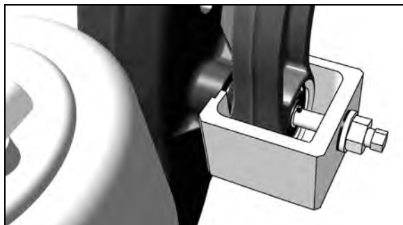
FIGURE 16: POSE D'UN EXTRACTEUR
