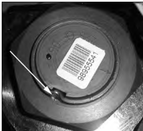
FIGURE 20 : MARQUE DE POINÇON D'ÉCROU DE FIXATION
