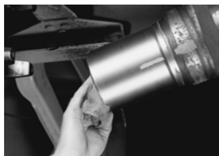
FIGURE 23: NETTOYER LA GRAISSE DU MANCHON CANNELÉ
