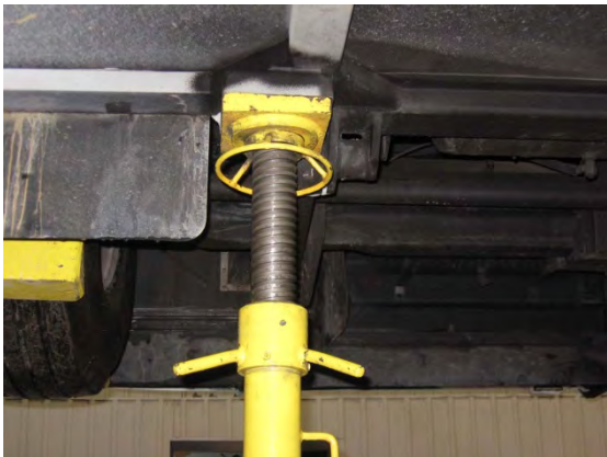
FIGURE 17: CHANDELLE AU SUPPORT DE LEVAGE - À L'ARRIÈRE DE L'ESSIEU AVANT, CÔTÉ ROUTE
