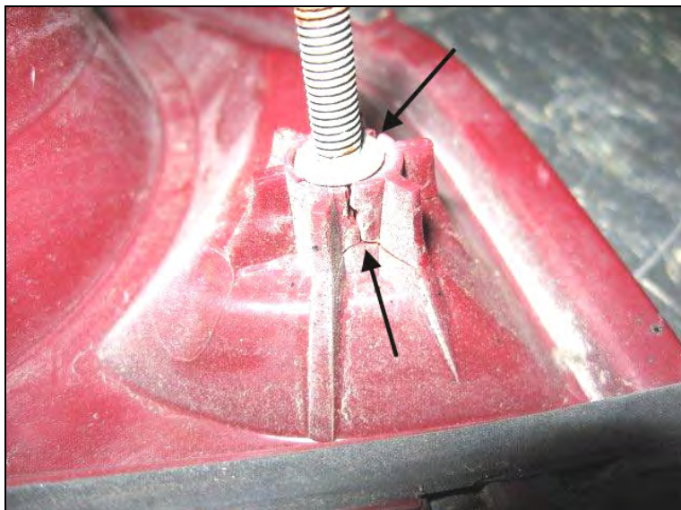
FIGURE 2: Fissures au bossage et aux nervures dues à l'utilisation de dégraissant à moteur
