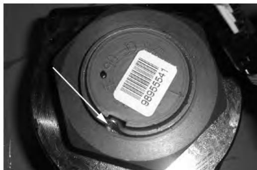
FIGURE 13 : MARQUE DE POINÇON D'ÉCROU DE FIXATION
