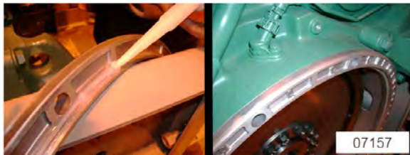
FIGURE 11: INSTALLATION DE L'ENTRETOISE D'ESPACEMENT
