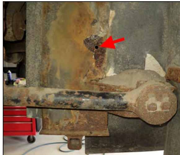
FIGURE 7: TROU PERCÉ DANS LE CHÂSSIS
