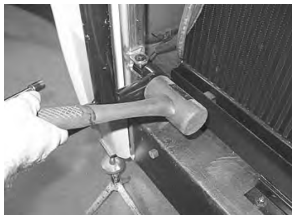
FIGURE 66: RÉGLAGE DE BRAS DE PANTOGRAPHE
