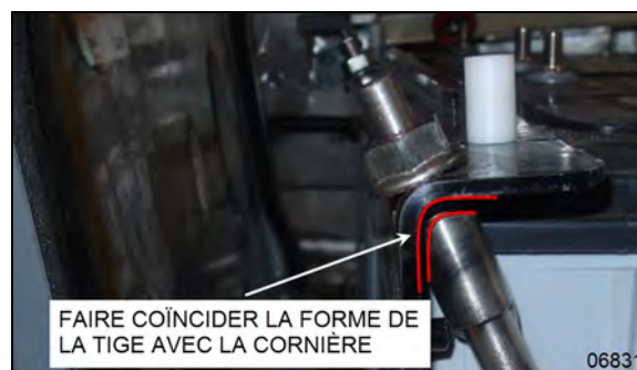
FIGURE 51 : BOUT DE LA TIGE COÏNCIDE AVEC LA CORNIÈRE
