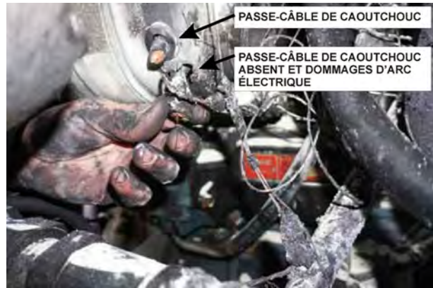
Figure 22: Incendie du compartiment moteur causé par le frottement du câble de puissance sur le boîtier métallique de l'alternateur Bosch T1. Le passe-câble de caoutchouc n'était pas en place au moment de l'incendie. Des dommages causés par un puissant arc électrique sont visibles.
