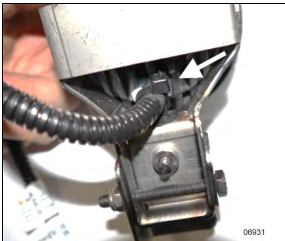
FIGURE 100: HARNAIS FIXÉ AU SUPPORT
