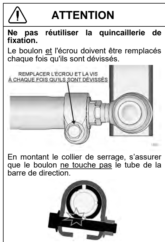
FIGURE 32 : BARRE DE DIRECTION D'ESSIEU AVANT RIGIDE
