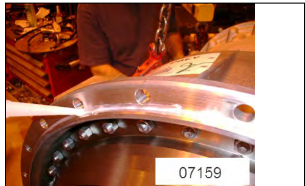
FIGURE 12: APPLICATION DE SILICONE AU CARTER DE BOÎTE DE VITESSES
