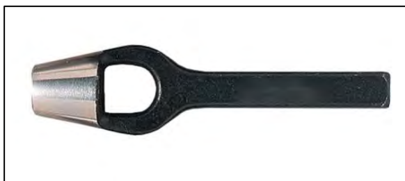
FIGURE 2: POINÇON EMPORTE-PIÈCE, 1/2" (TYPE POINÇON À CUIR)
