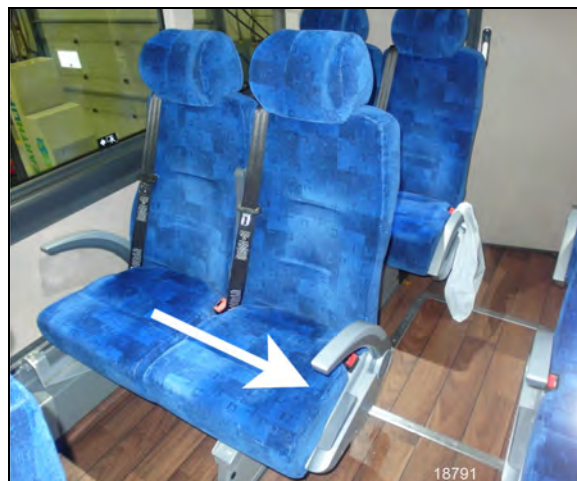
FIGURE 84: TIRER POUR DÉBLOQUER LA ROTATION
