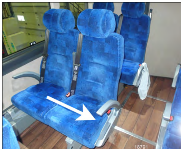
FIGURE 28: TIRER POUR DÉBLOQUER LA ROTATION
