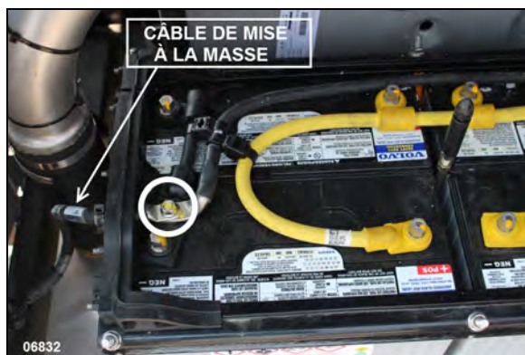
FIGURE 43: DÉCONNECTER LE CÂBLE DE MISE À LA MASSE EN PREMIER
