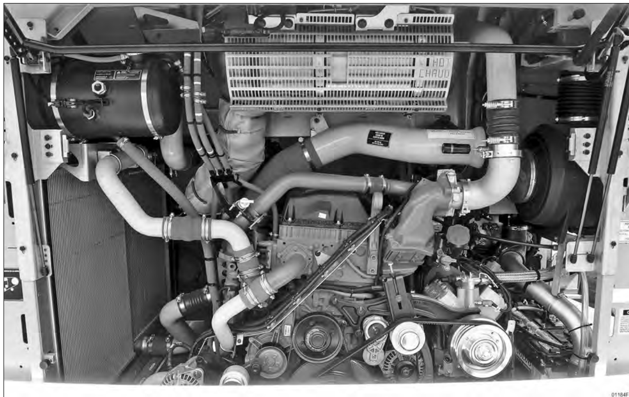
FIGURE 13 : COMPARTIMENT MOTEUR SÉRIE X TYPIQUE
