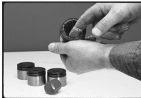
FIGURE 28: GRAISSAGE DES COUPELLES DE ROULEMENT
