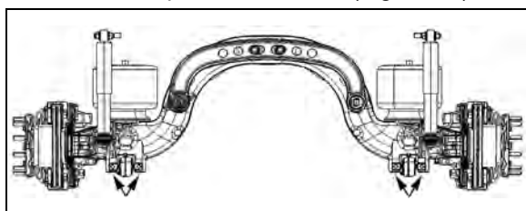
FIGURE 15: POINTS DE LEVAGE SOUS L'ESSIEU AUXILIAIRE 11023
