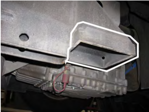
FIGURE 15: SUPPORT DE LEVAGE AU CHÂSSIS OPTIONNEL - À L'ARRIÈRE DE L'ESSIEU AUXILIAIRE
