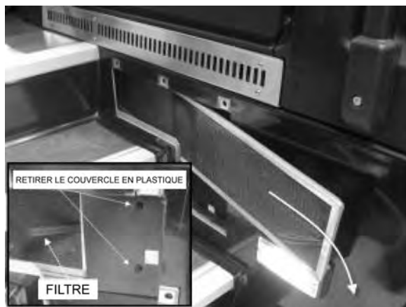
FIGURE 18 : DÉMONTAGE DES FILTRES À AIR DE L'UNITÉ DU CONDUCTEUR
