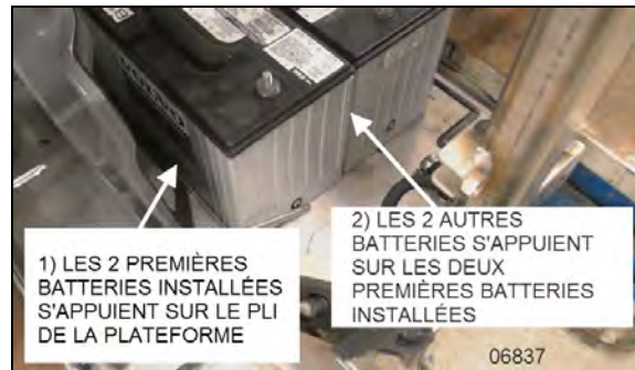
FIGURE 50: POSITION ADÉQUATE DES BATTERIES
