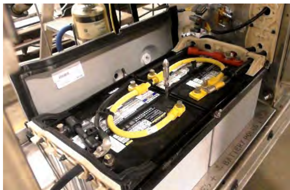
FIGURE 42: BATTERIES AVEC COUVERCLE RETIRÉ
