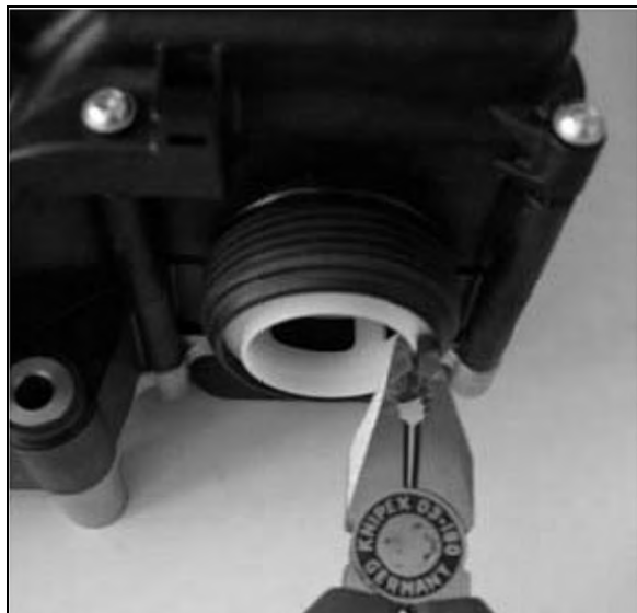
FIGURE 13 : REMPLACEMENT DE L'ÉLÉMENT FILTRE DU MODULE DE POMPE
