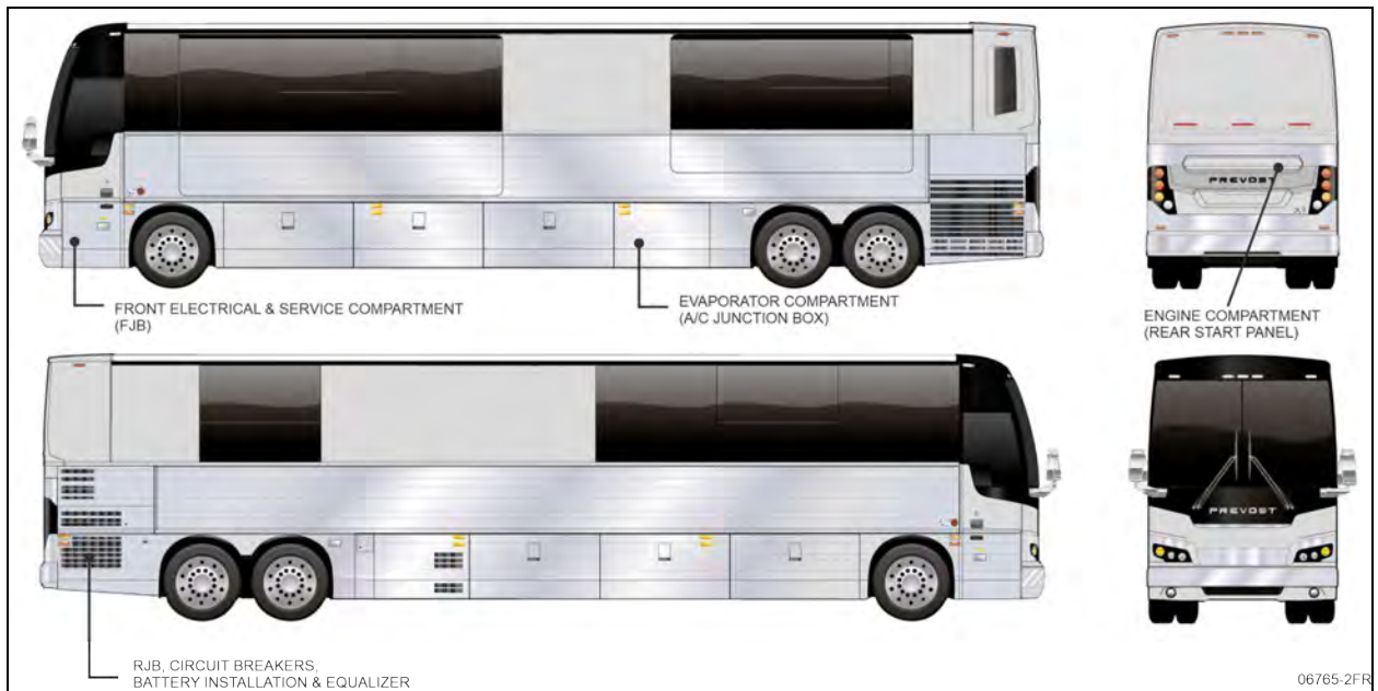
FIGURE 14 : COMPARTIMENTS ÉLECTRIQUES (X3-45 VIP)
