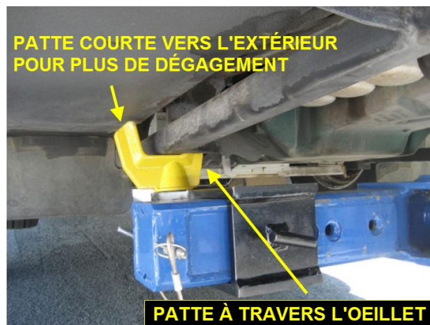
FIGURE 62: EMPLACEMENT RECOMMANDÉ POUR LE LEVAGE PAR LES LONGERONS – VÉHICULE AVEC OEILLETS DE REMORQUAGE ARRIÈRE
