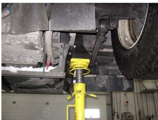
FIGURE 19: CHANDELLE AU SUPPORT DE LEVAGE - À L'ARRIÈRE DE L'ESSIEU AUXILIAIRE, CÔTÉ ROUTE
