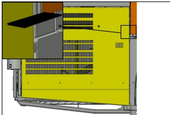
FIGURE 126: UTILISER UNE RÈGLE POUR VÉRIFIER SI LES SURFACES SONT AU MÊME NIVEAU
