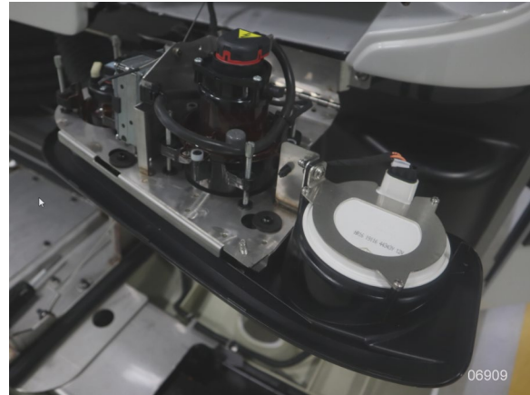
FIGURA 69 ACCESO A LAS BOMBILLAS Y CONECTORES
