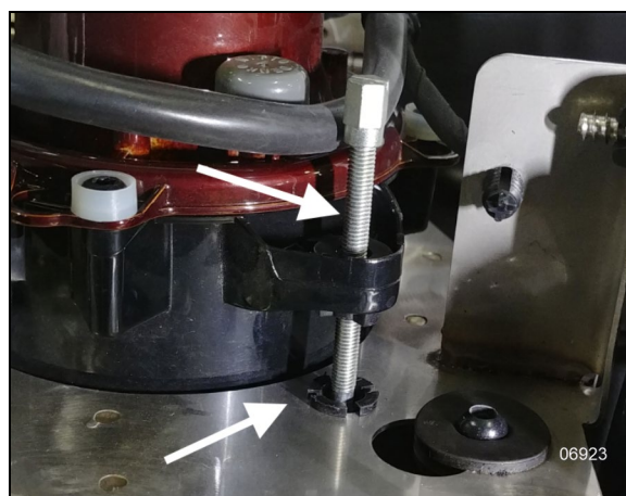
FIGURA 74: DESABROCHE LOS SOPORTES DE PLÁSTICO
