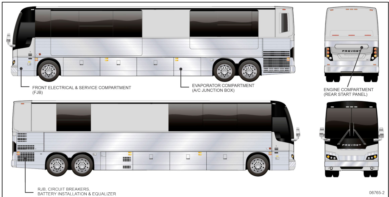
FIGURA 14: COMPARTIMENTOS ELÉCTRICOS (X3-45 VIP)
