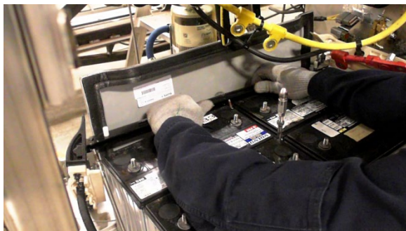
FIGURA 47: RETIRE EL ÁNGULO TRASERO
