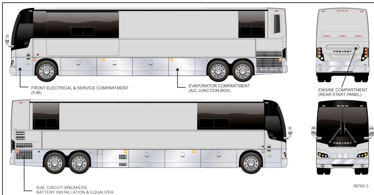
FIGURA 15: COMPARTIMENTOS ELÉCTRICOS (X3-45 VIP COMMERCIAL BUS SHELL)
