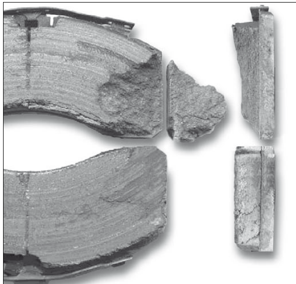
FIGURE 20: PLAQUETTE DE FREIN AVEC DÉGRADATION MINEURE (TOLÉRÉE)
