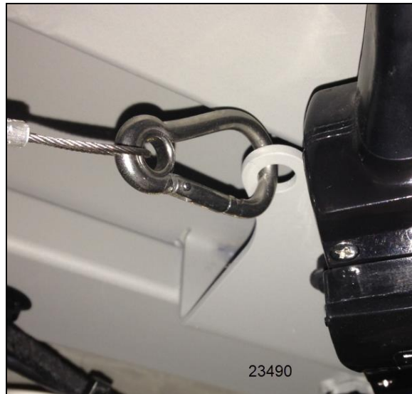
FIGURE 56: DÉTACHER LE CÂBLE DE SÛRETÉ
