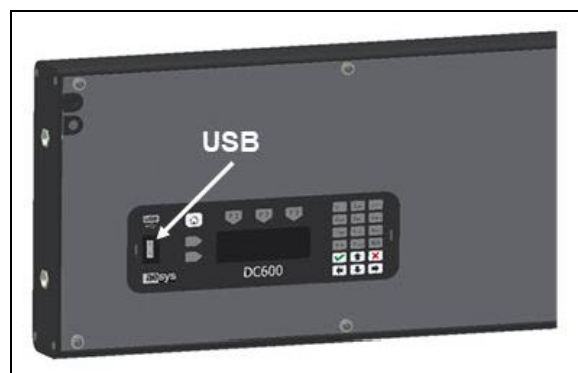
FIGURE 19: ÉCRAN LCD DE L'ENSEIGNE DE DESTINATION (SÉRIE 600 MONTRÉE) 23123-1
