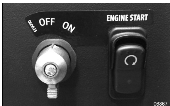
FIGURE 60: AGENCEMENT DES COMMUTATEURS AVEC UN MODULE DE DÉMARRAGE
