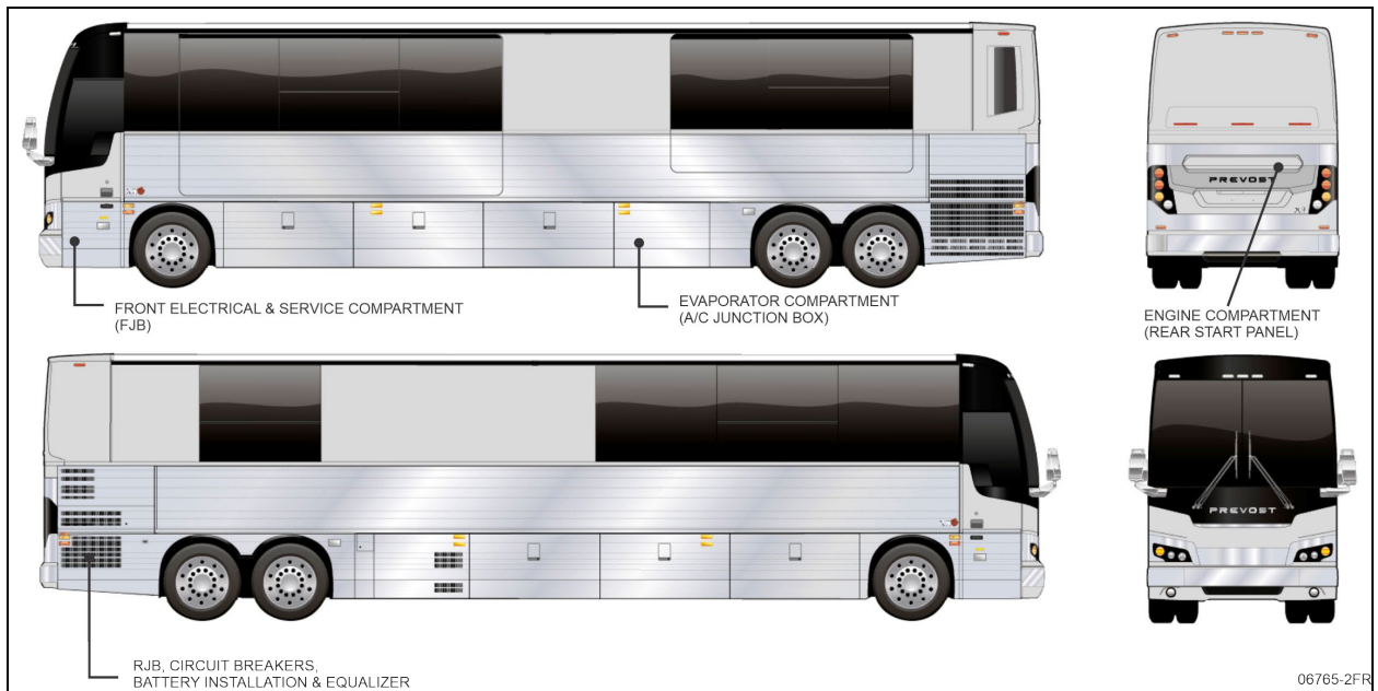
FIGURE 14 : COMPARTIMENTS ÉLECTRIQUES (X3-45 VIP)
