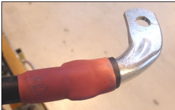
Figure 14: Le câble de puissance ne doit pas être plié de façon excessive juste avant la cosse. Utiliser une cosse coudée pour éviter les contraintes mécaniques.
