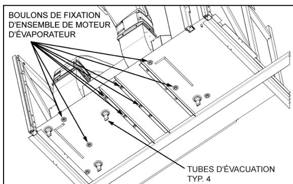
FIGURE 56: BOULONS DU MOTEUR DE
