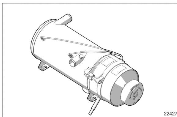
FIGURE 104 : PRÉCHAUFFEUR EBERSPÄCHER (30KW)
