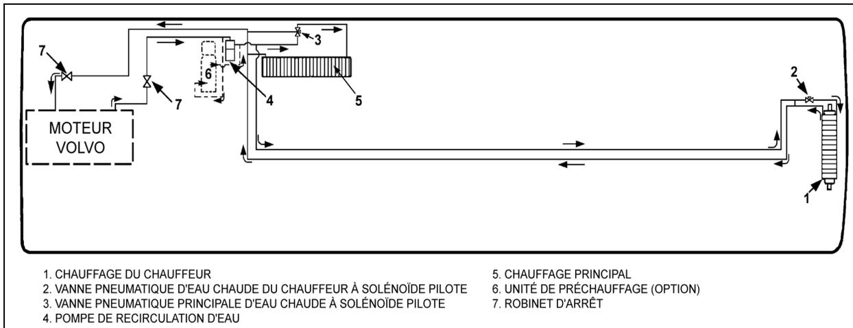
FIGURE 6 : GROS SYSTÈME DE CVC SÉRIE X3 – CIRCUIT DE CHAUFFAGE
