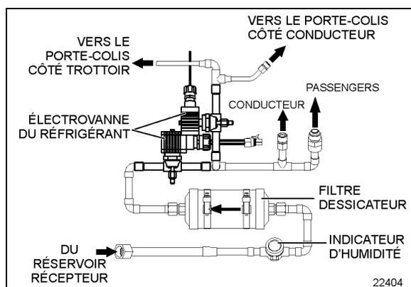
FIGURE 69 : ÉLECTROVANNE DE RÉFRIGÉRANT LIQUIDE DANS LE COMPARTIMENT DE CONDENSEUR (SÉRIE X)
