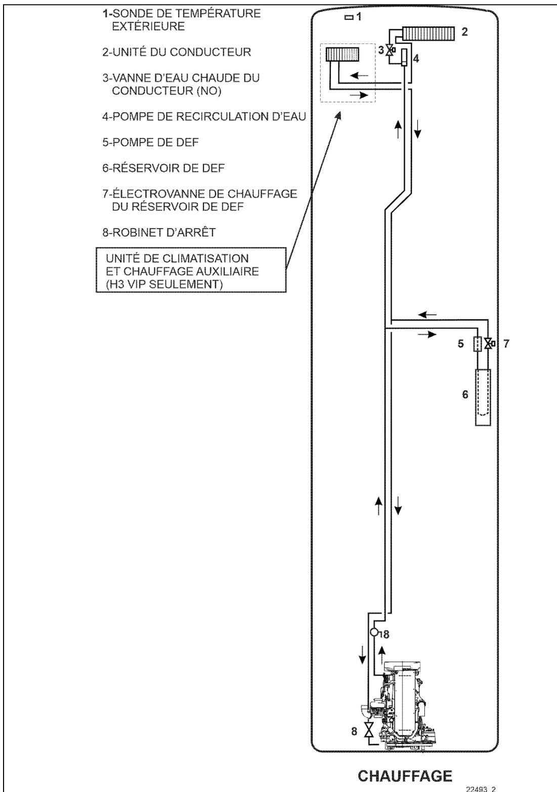
FIGURE 9 : PETIT SYSTÈME CVC DE SÉRIE H3 – CIRCUIT DE CHAUFFAGE
