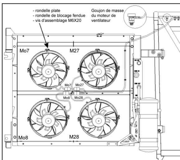
FIGURE 60 : VENTILATEURS DU CONDENSEUR
