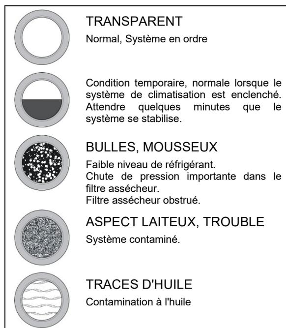
FIGURE 65 : CONDITIONS POUVANT ÊTRE OBSERVÉES DANS L'INDICATEUR D'HUMIDITÉ
