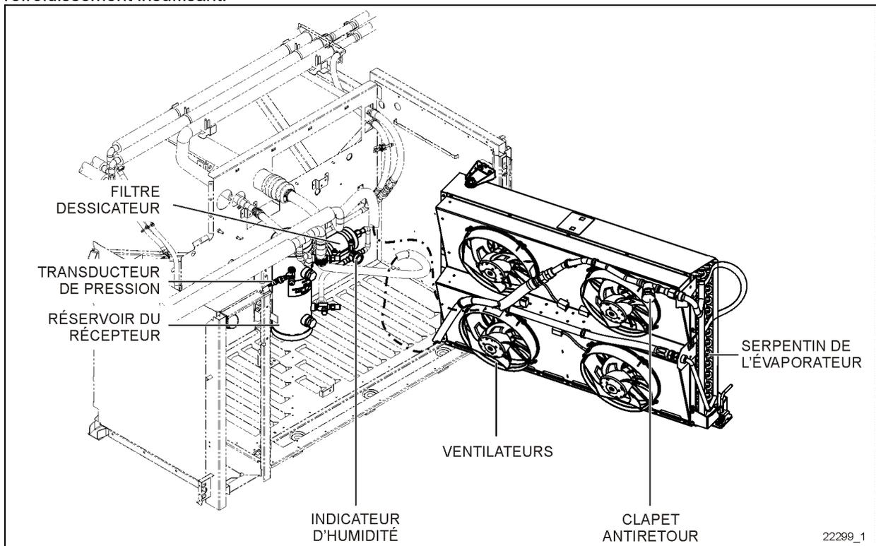
FIGURE 58: CONDENSEUR DE CLIMATISATION – GROS SYSTÈME DE CVC
