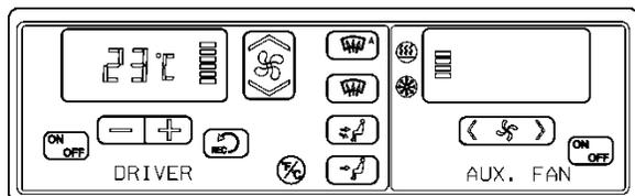
FIGURE 103 : MODULE DE COMMANDE – PETIT SYSTÈME DE CVC 22286
