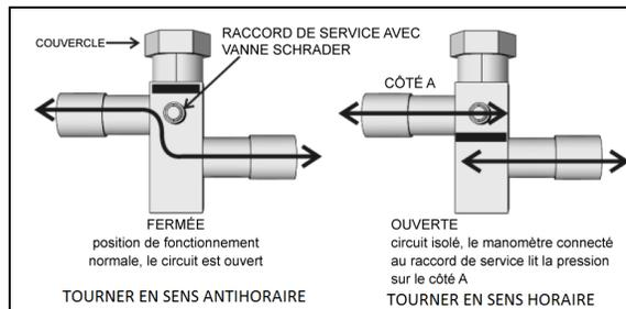
FIGURE 66 : ROBINET D'ARRÊT DU CIRCUIT DE REFROIDISSEMENT
