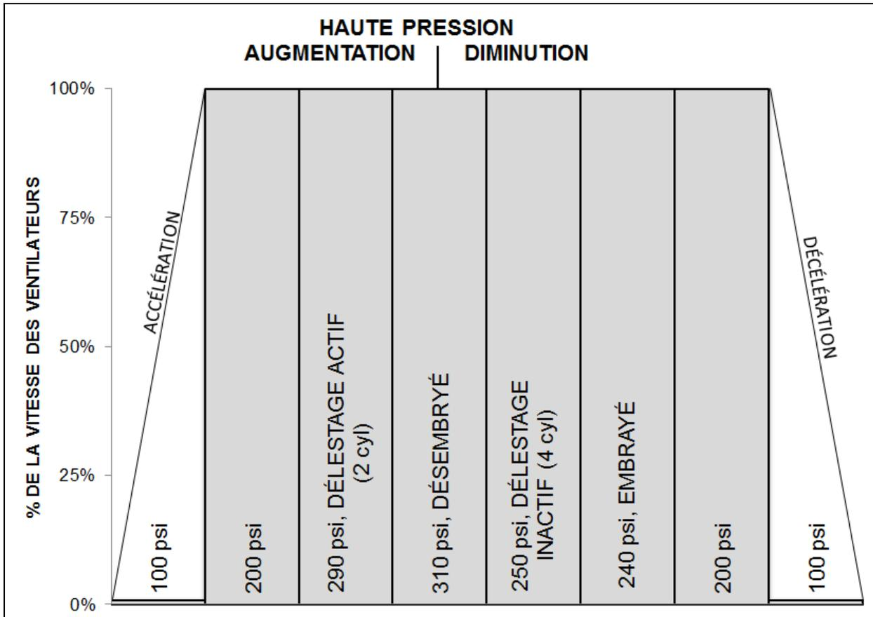
FIGURE 59: VITESSE DES VENTILATEURS DU CONDENSEUR ET ÉVÈNEMENTS AU COMPRESSEUR SELON LA PRESSION DU CÔTÉ ÉLEVÉ.
