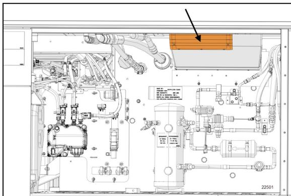
FIGURE 107: COUVERCLE D'ACCÈS DES MODULES
