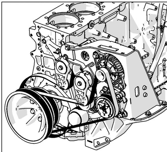
FIGURE 100 PETIT COMPRESSEUR DE CLIMATISATION DE LA SÉRIE X3
