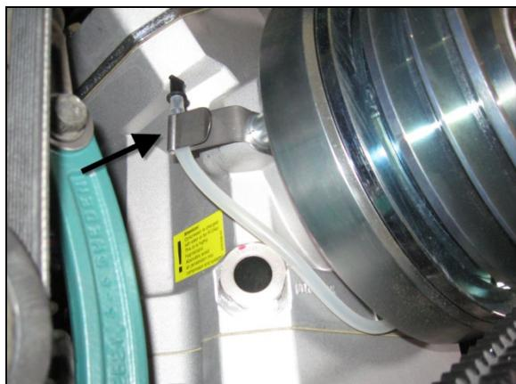
FIGURE 44 : TUBE COLLECTEUR D'HUILE DU JOINT D'ARBRE
