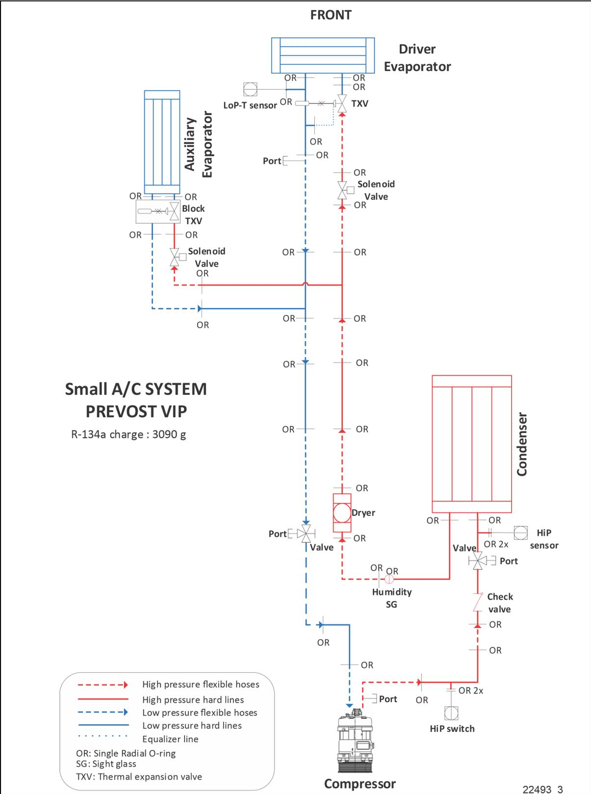
FIGURE 7: CIRCUIT DE RÉFRIGÉRANT PETIT SYSTÈME DE CVC SÉRIES X3
