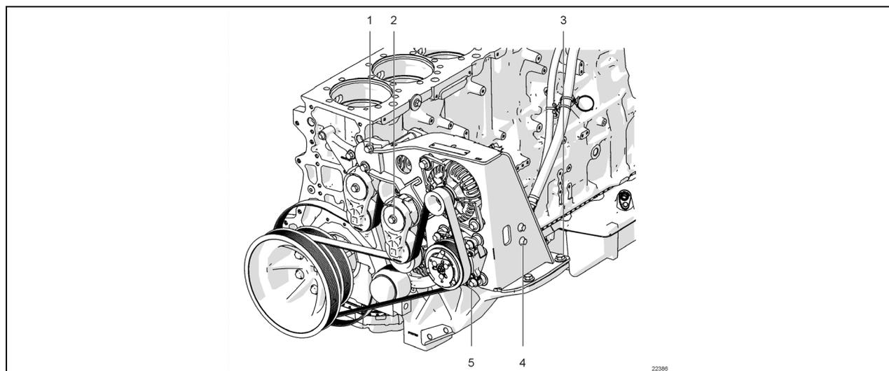
**BOULONNERIE DU PETIT SYSTÈME DE CLIMATISATION**
