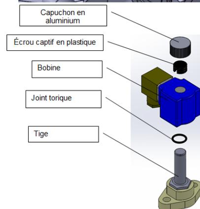
6. Installer la nouvelle bobine « clip-on ».
