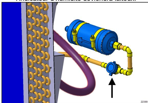
FIGURE 97 : REGARD DE L'INDICATEUR D'HUMIDITÉ
