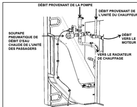
FIGURE 87: SOUPAPE PNEUMATIQUE DE DÉBIT D'EAU CHAUDE DE L'UNITÉ DES PASSAGERS 22240
