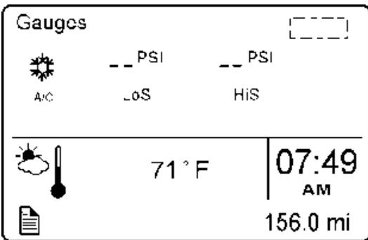
Cette fonction affiche la pression d'aspiration (LoS=low side) et de refoulement (HiS=high side) du compresseur du système de climatisation.
