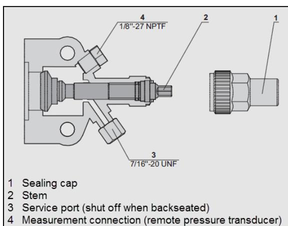
FIGURE 96 : ROBINET D'ARRÊT DU COMPRESSEUR EN POSITION SIÈGE AVANT
