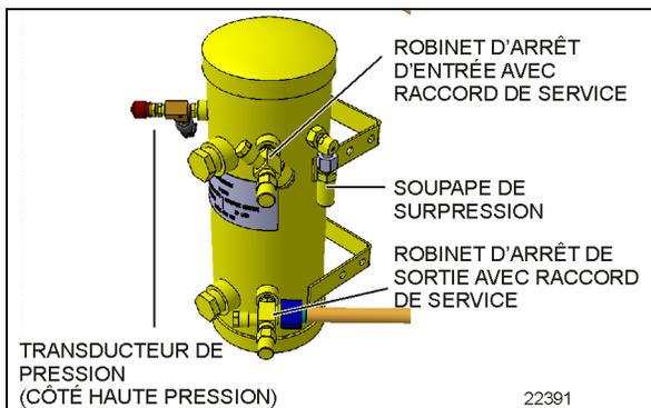
FIGURE 63: RÉSERVOIR DE RÉSERVE SÉRIE X
