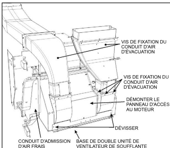
FIGURE 54 : COMPARTIMENT DE L'ÉVAPORATEUR SÉRIE H3
