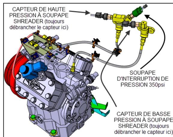
FIGURE 43: CAPTEURS DE PRESSION
