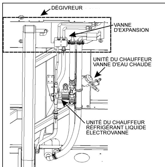
FIGURE 68 : ÉLECTROVANNE DU RÉFRIGÉRANT DE L'UNITÉ DU CONDUCTEUR
