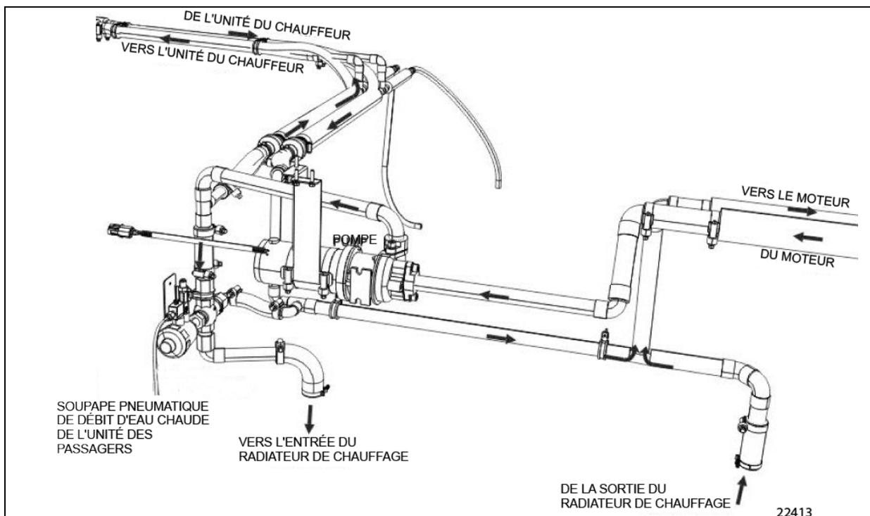
FIGURE 75 : INSTALLATION DE LA POMPE DE CIRCULATION D'EAU CHAUDE (GROS SYSTÈME DE CVC DES SÉRIES H3)
