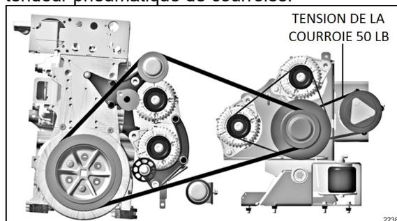
FIGURE 99: DISPOSITION DES COURROIES AVEC PETIT COMPRESSEUR DE CLIMATISATION SÉRIE X3
