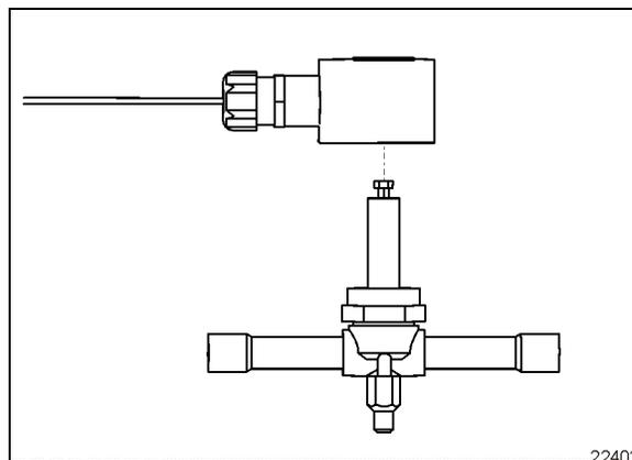
FIGURE 70 : ÉLECTROVANNE DE RÉFRIGÉRANT TYPIQUE
