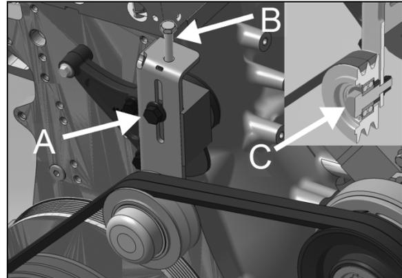
Figure 38: TENDEUR SUR LE GROS SYSTÈME DE CVC 22381
