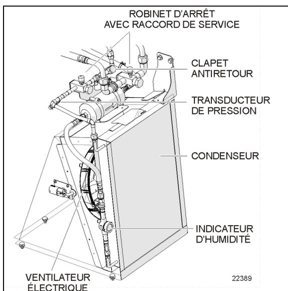
FIGURE 101: CONFIGURATION DE CONDENSEUR X3-45 VIP
