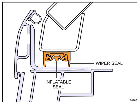
FIGURE 29: ASSEMBLAGE DU JOINT D'ÉTANCHÉITÉ
