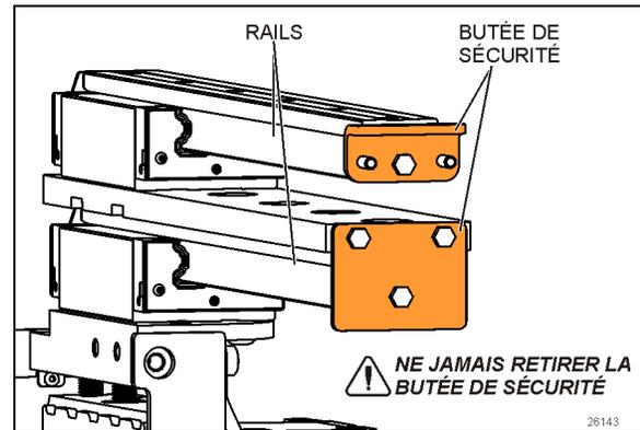
FIGURE 67: BUTÉES DE SÉCURITÉ SUR LES RAILS
