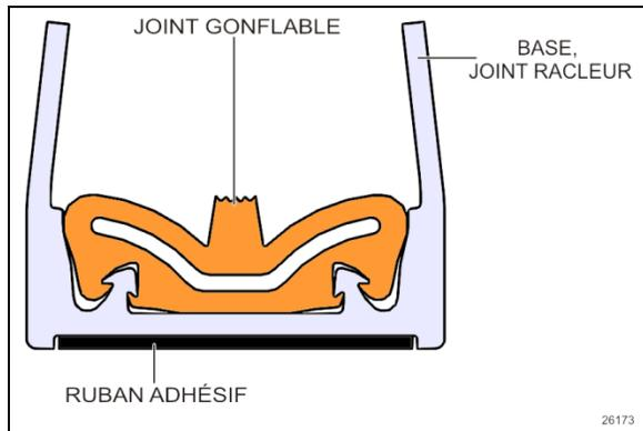
FIGURE 1: ENSEMBLE DE JOINT GONFLABLE DEUX PIÈCES
