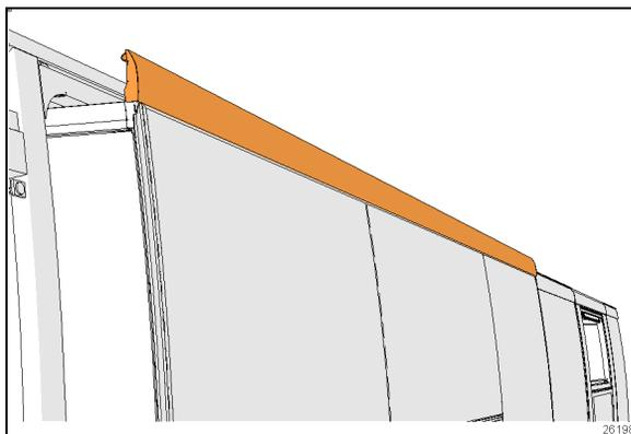
FIGURE 18: EXTRUSION SUPÉRIEURE
