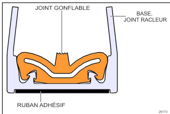
FIGURE 8: ASSEMBLAGE DE JOINT EN DEUX PARTIES
