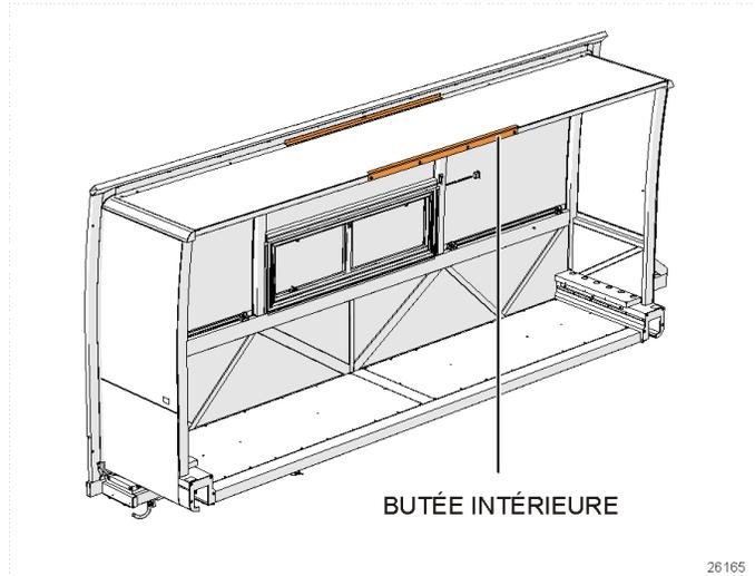
FIGURE 4: BUTÉE SUPÉRIEURE INTÉRIEURE
