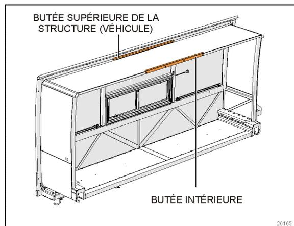
FIGURE 9: BUTÉE SUPÉRIEURE INTÉRIEURE
