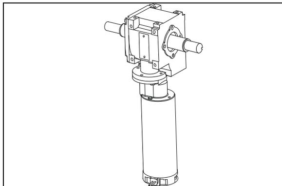
FIGURE 39: MOTEUR ÉLECTRIQUE ET RÉDUCTEUR DE VITESSE
