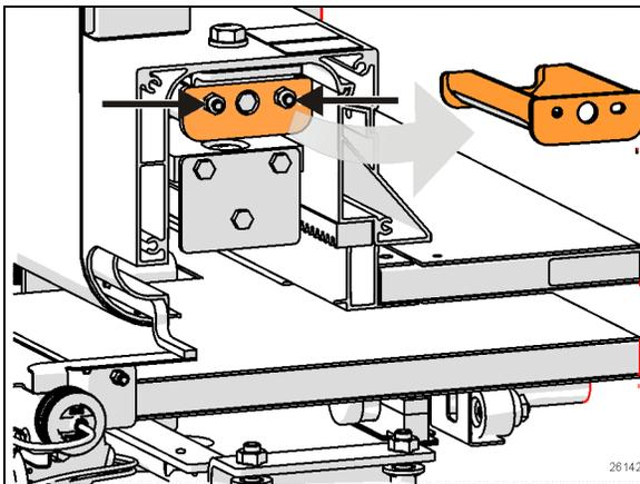
FIGURE 66 ÉCROUS DE MONTAGE DE LA BUTÉE
