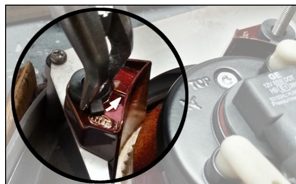
FIGURE 83: VERROUILLER LES TIGES FILETÉES
