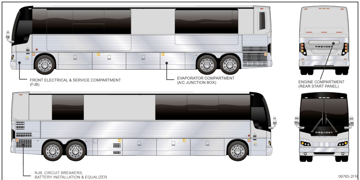
FIGURE 18 : COMPARTIMENTS ÉLECTRIQUES (X3-45 VIP)
