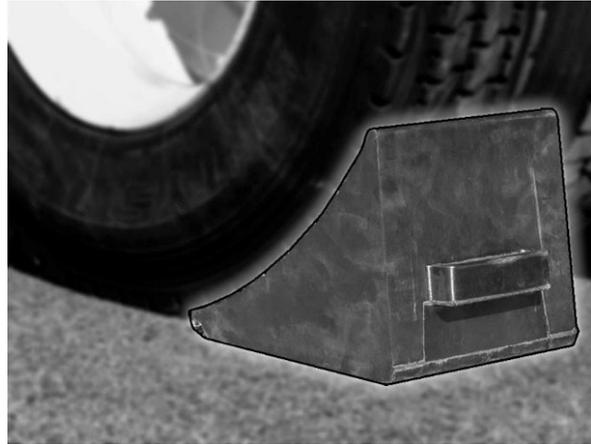
FIGURE 21 : CALER LES ROUES AVANT ET ARRIÈRE
