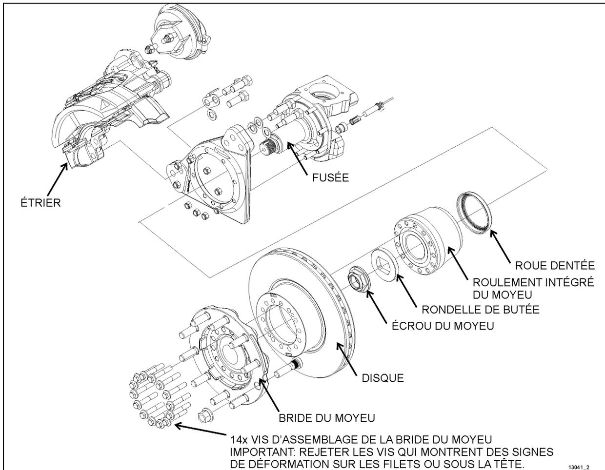
FIGURE 36 : ASSEMBLAGE MOYEU ET DISQUE D'ESSIEU AVANT
