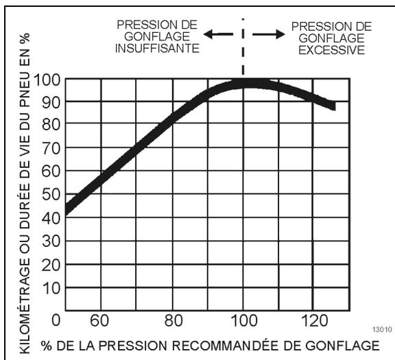
FIGURE 46 : DURÉE DE VIE/PRESSION DE GONFLAGE DES PNEUS
