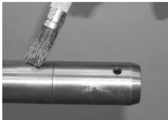
FIGURE 19 : APPLIQUER LA GRAISSE GLEITMO 805
