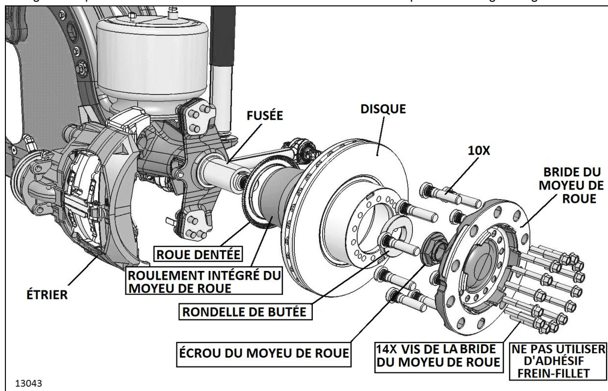
FIGURE 7 : ASSEMBLAGE MOYEU ET DISQUE D'ESSIEU AUXILIAIRE
