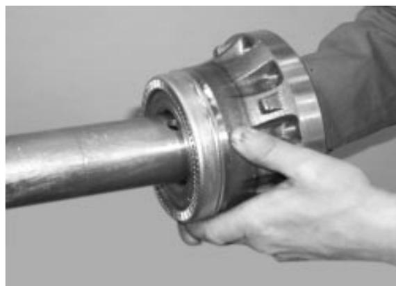
FIGURE 20 : FAIRE GLISSER LE ROULEMENT DE MOYEU INTÉGRÉ PAR-DESSUS LA FUSÉE
