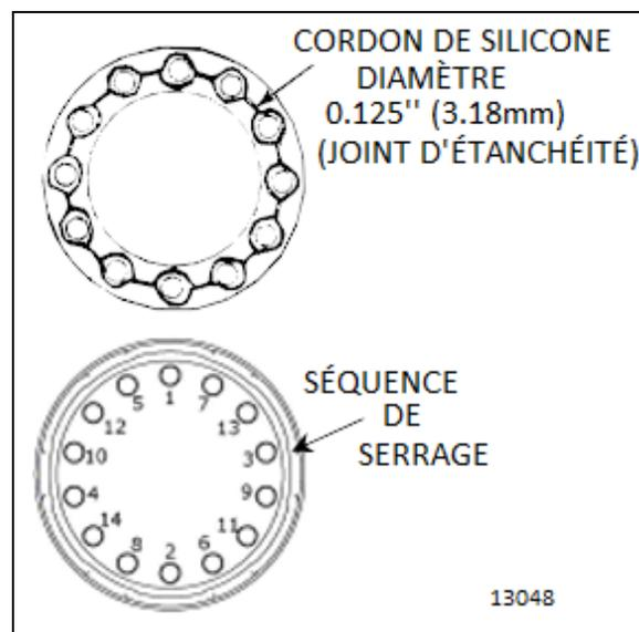
FIGURE 38 : SÉQUENCE DE SERRAGE DE BRIDE D'ESSIEU
