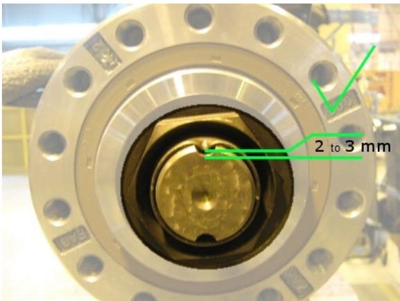
FIGURE 25: CORRECT – 2 À 3 MM / 0.078 À 0.118 PO
