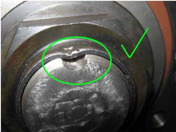
FIGURE 24: CORRECT - EMPÊCHE L'ÉCROU DE SE DESSERRER
