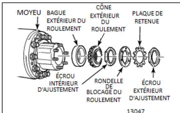
FIGURE 37 : MOYEU DE ROUE D'ESSIEU MOTEUR
