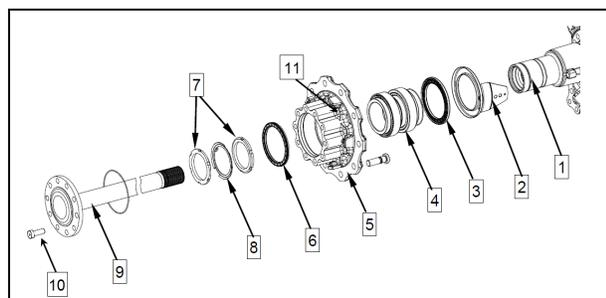
FIGURE 39: ASSEMBLAGE DE MOYEU D'ESSIEU DIRECTEUR ZF A-132
