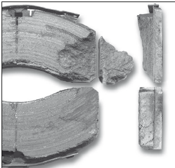
Figure 20: Plaquette de frein avec dégradation mineure (tolérée)
