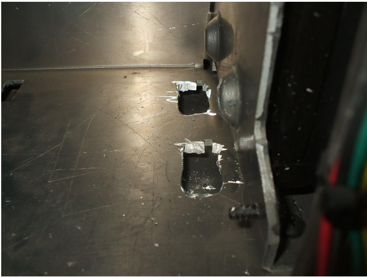
4. Agrandir les trous de fixation du haut à l'aide d'une mèche de 15/64 po.
