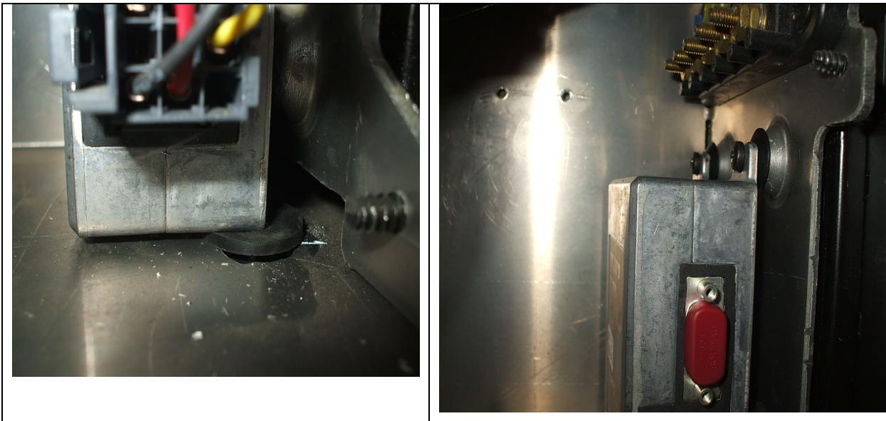
8. Effectuer un essai de continuité sur le module «Master ID» afin de s'assurer de son isolation électrique.
