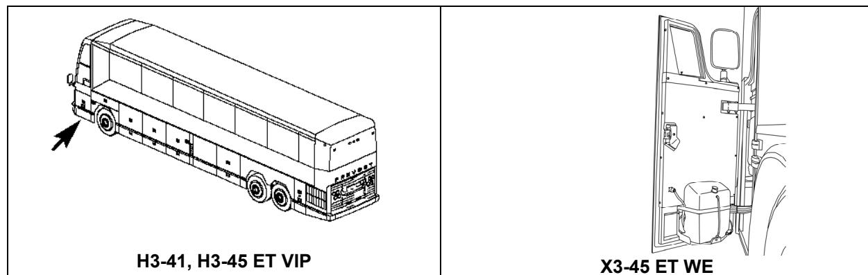
2. Localiser puis démonter le module électronique «Master ID».
