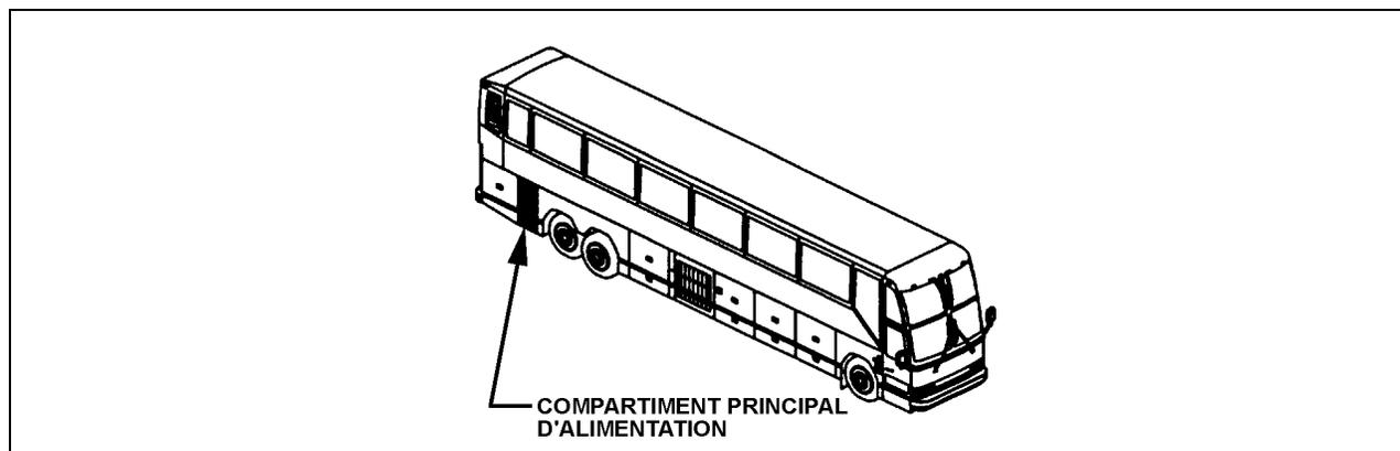
Figure 1 : Emplacement type du compartiment principal d'alimentation.
