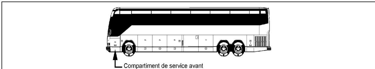
Figure 3 : Emplacement type du compartiment de service avant.
