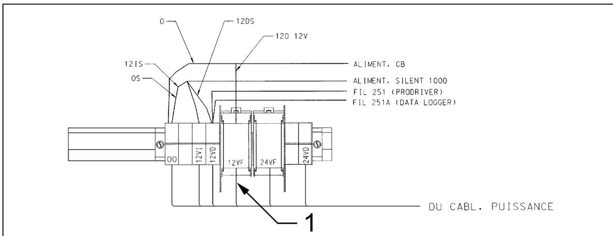
Figure 4 : Compartiment de service avant. (1) Câble à remplacer.
