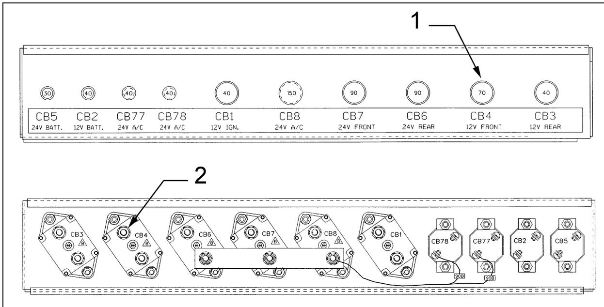
Figure 2 : (1) Vue de face du disjoncteur CB4 ; (2) Vue arrière du disjoncteur CB4.
